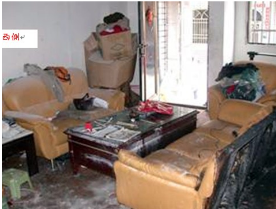
圖3：西側沙發椅未受火勢波及燒損，且地面上遺留著搶救後乾粉滅火器藥劑痕跡。
