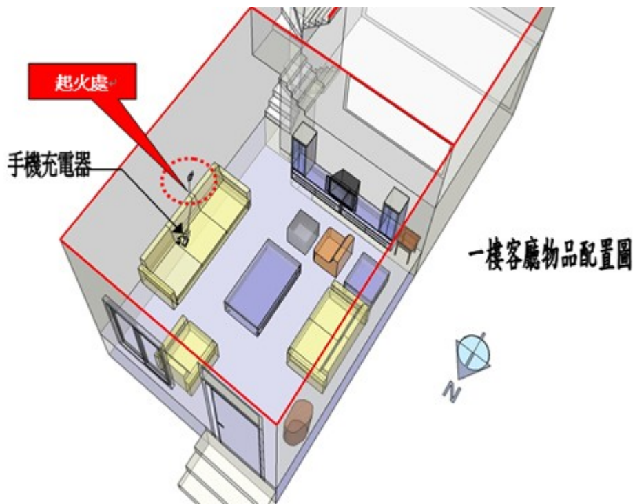
圖 1：現場物品位置圖（起火手機充電器於客廳沙發坐墊上位置）。
