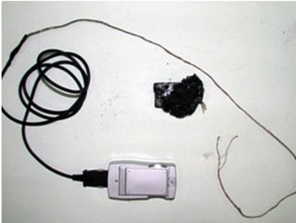
圖 10：手機充電器組，充電器插頭下方電源線呈現半斷線短路。
