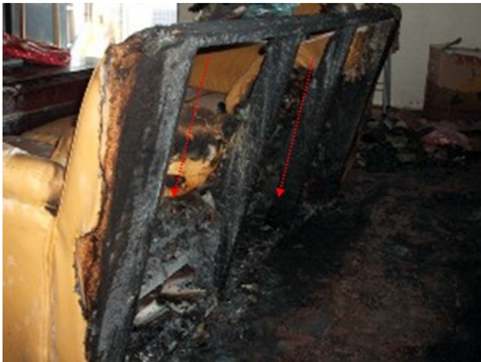
圖 7：沙發背面上方燒損較下方嚴重，顯見火流由上往下延燒。
