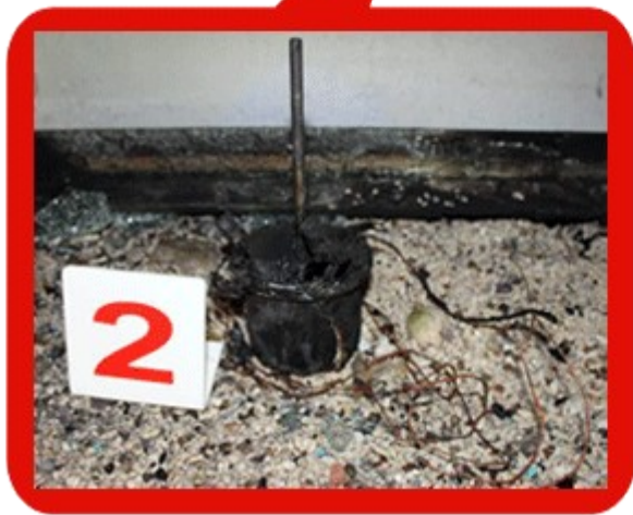
圖 1 水族箱火災燃燒後之情形，牆壁明顯燻黑變色，水族箱過濾裝置之馬達銅線完整無熔珠情形
