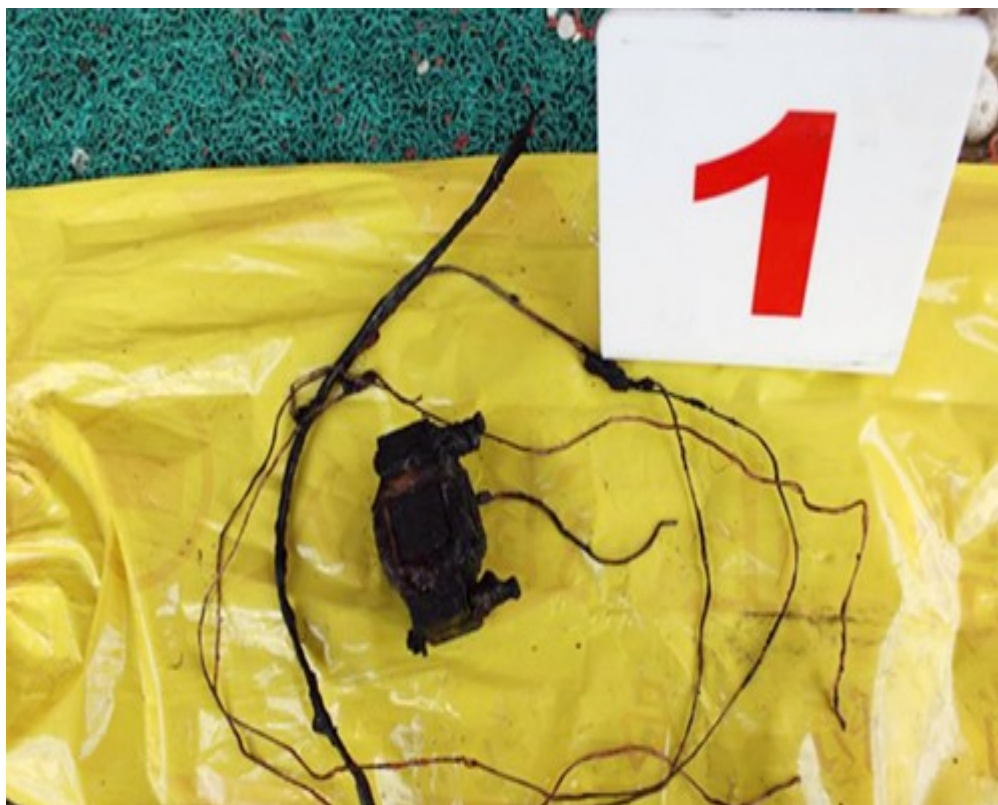
圖 2 疑似加溫器燃燒後之情形
