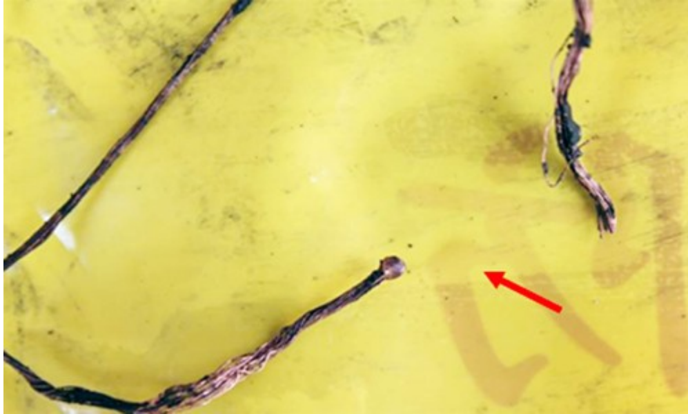
圖 3 疑似加溫器熔斷的銅線，明顯有熔珠情形
