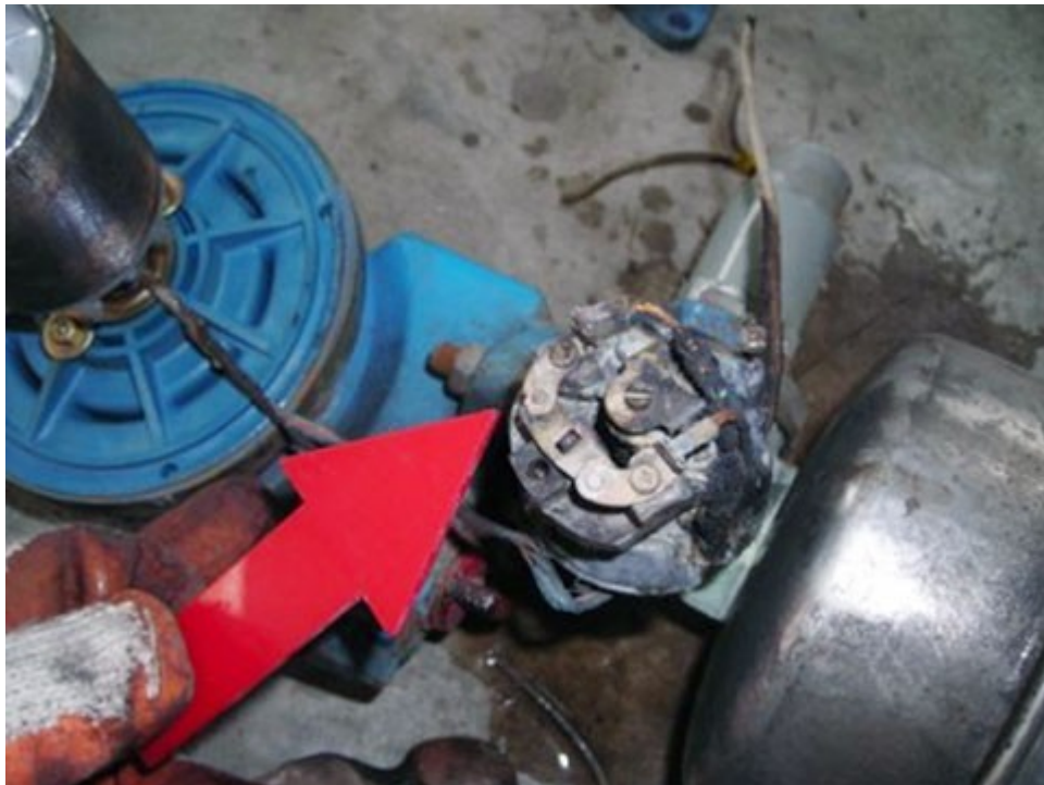
圖 8：壓力開關接點燒熔。
