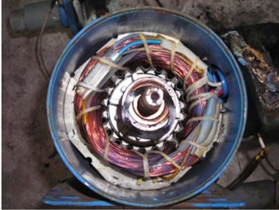
圖 5：馬達內部軸承、線圈未受燒。
