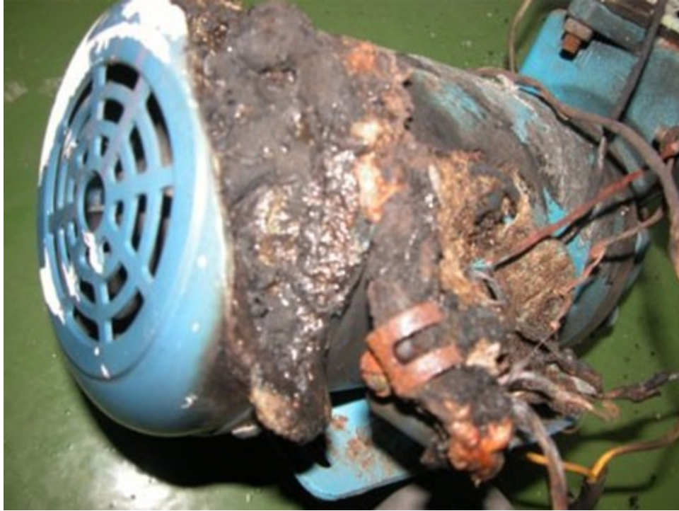
圖 3：馬達風扇外殼靠近接線盒處燒熔。
