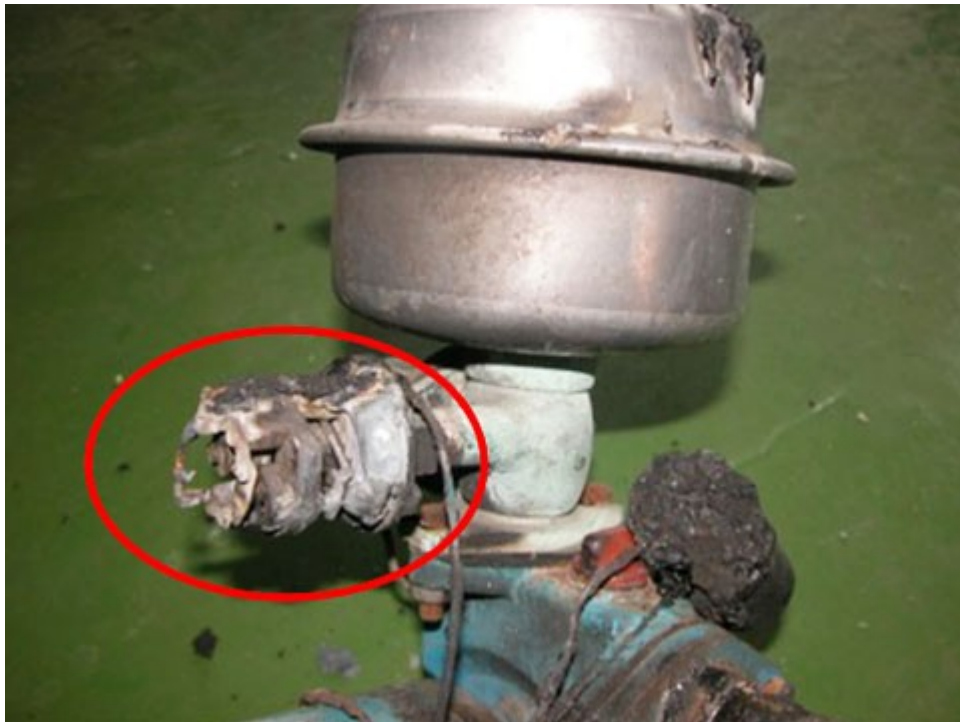
圖 2：泵浦壓力開關的塑膠外殼燒熔。
