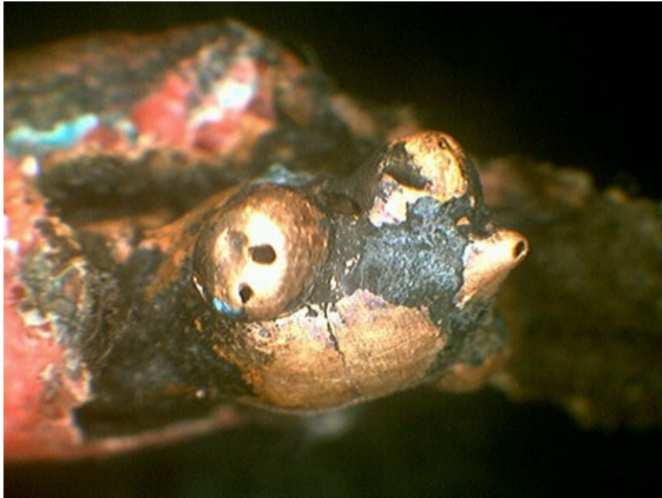
圖 7：電纜線短路熔痕
