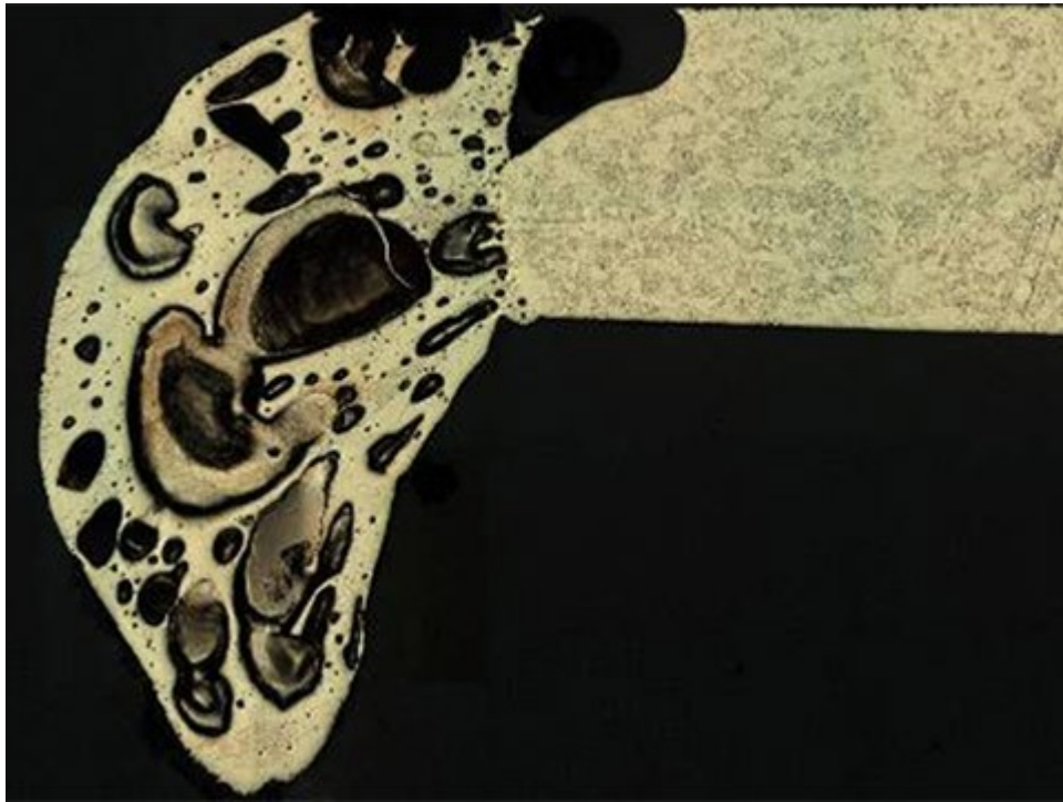
圖3：發現該電源配線熔斷處明顯呈通電中短路燒熔情形。
