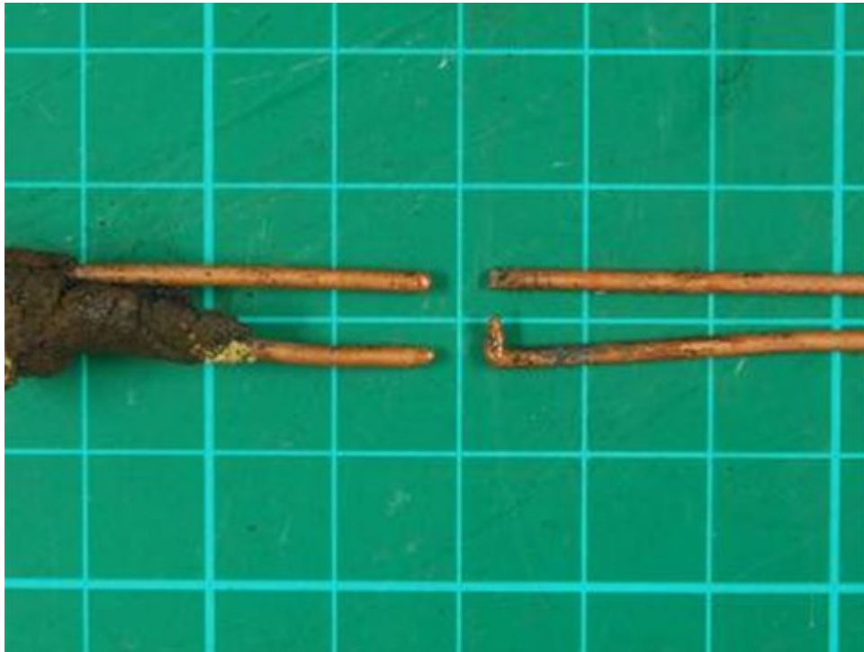
圖 2：發現該電源配線熔斷處明顯呈通電中短路燒熔情形。
