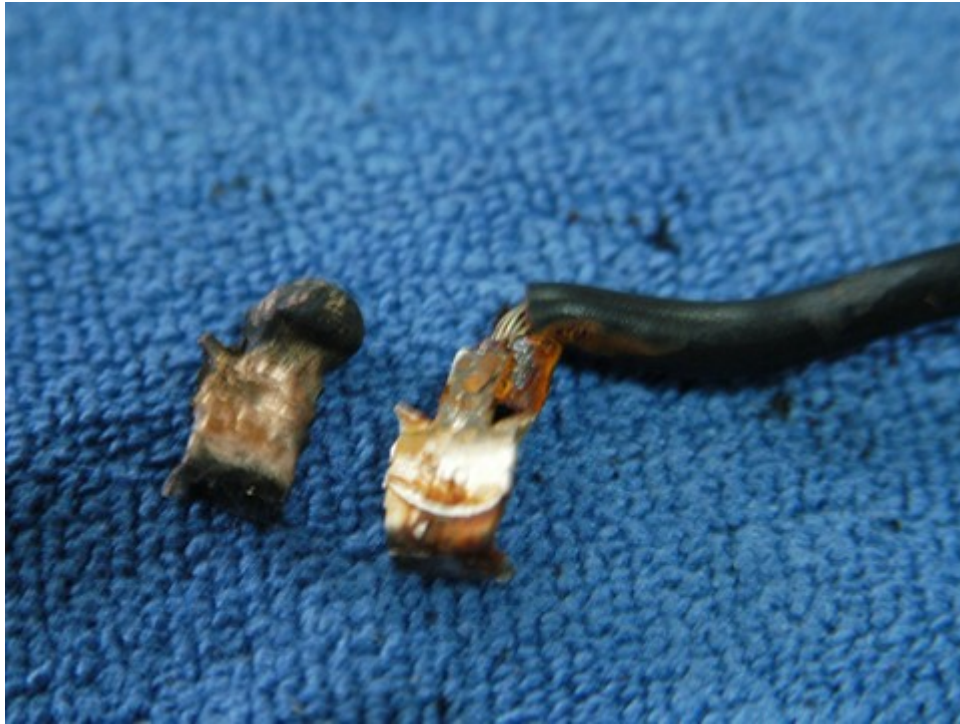
圖 5：左側為過載保護器引出接點（A）短路熔痕，右側為正常端子。
