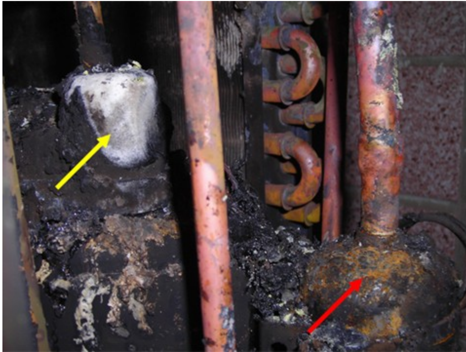
圖 2：壓縮機樹脂上蓋受燒泛白，紅箭頭所為儲液器上方生鏽變黃。
