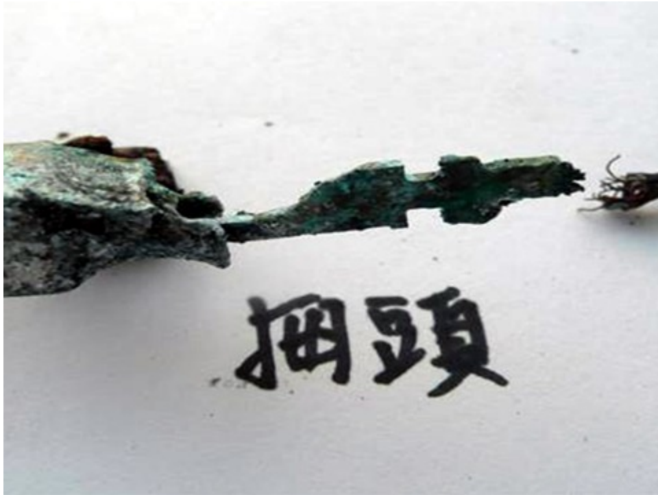
圖 5 將拆下冷氣機插座重建原裝配情形，發現該冷氣機電源插頭銅片有嚴重燒熔燒斷情形。
