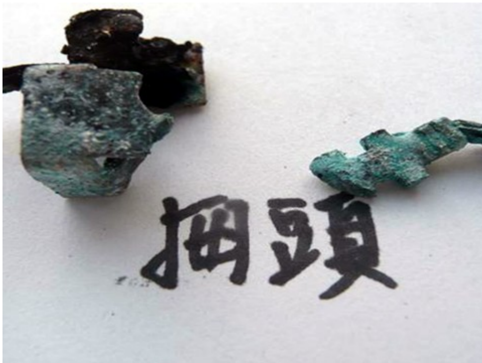
圖 6 將拆下冷氣機插座重建原裝配情形，發現該冷氣機電源插頭銅片有嚴重燒熔燒斷情形。
