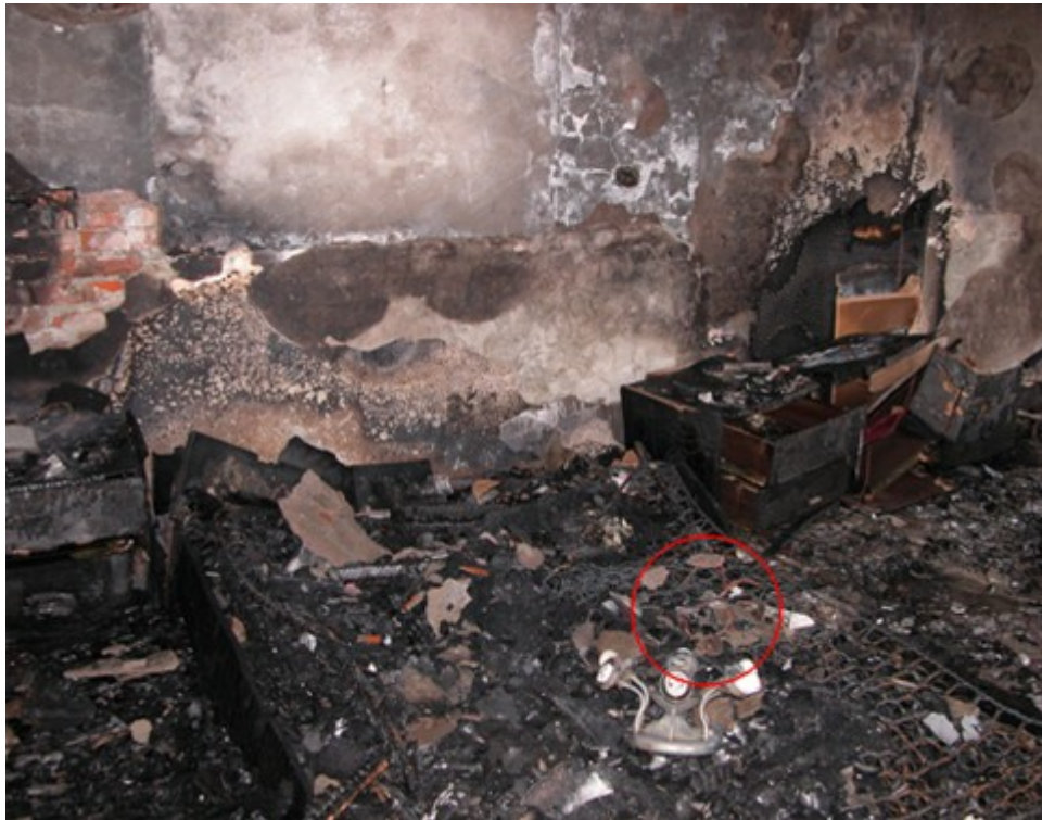
圖 1：起火床鋪上方遺留受燒後吹風機電源線
