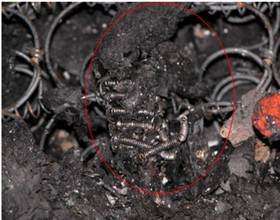
圖 2：移開寢具發現電源線一端為吹風機加熱絲
