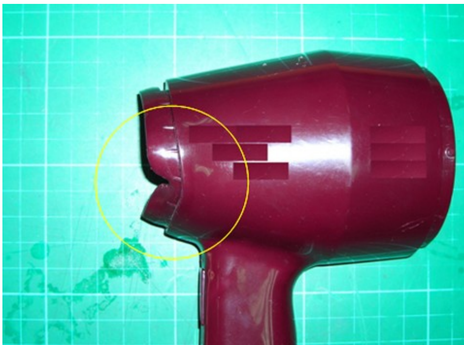
圖 4：實驗後吹風機風管後端受熱融化
