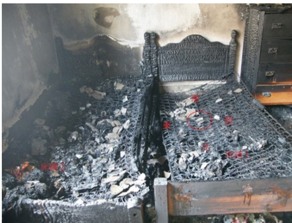
圖2：臥室1內部床舖附近毀損碳化情形以床舖1中間附近最為劇烈嚴重，中間紅色圓圈處遺留吹風機殘骸情形。
