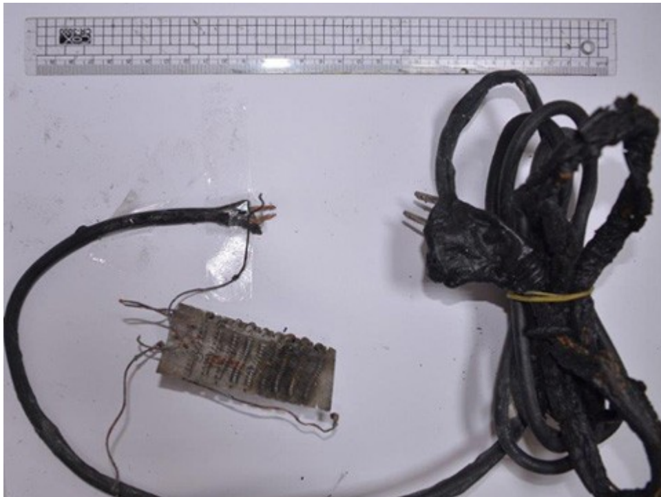
圖4：吹風機殘骸以出風口電熱絲及雲母片殘骸受燒灼黑變色情形較劇。
