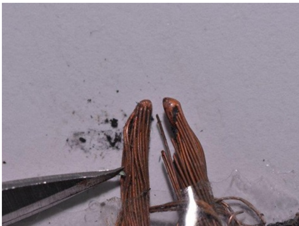
圖5：吹風機電源線路採證後，經消防署鑑定分析結果為通電痕。
