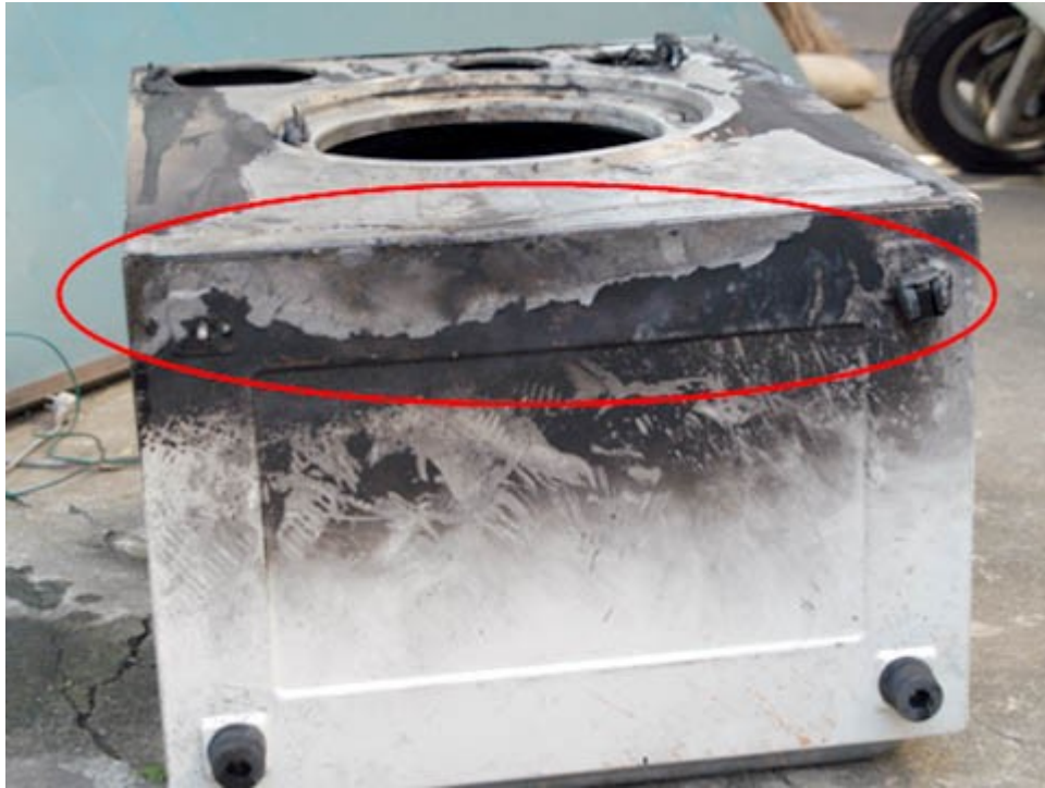
圖 3：烘衣機底部因塑膠拉門燒熔導致正面下方受燒嚴重。
