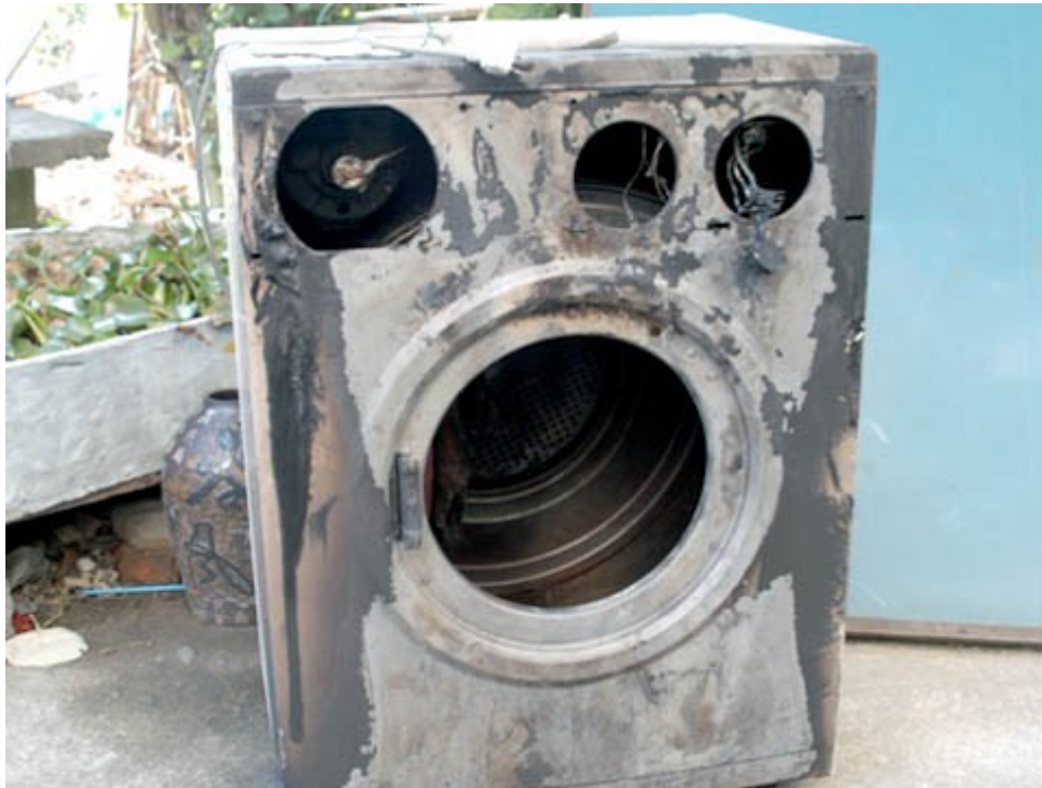
圖 1：烘衣機正面受燒情形。
