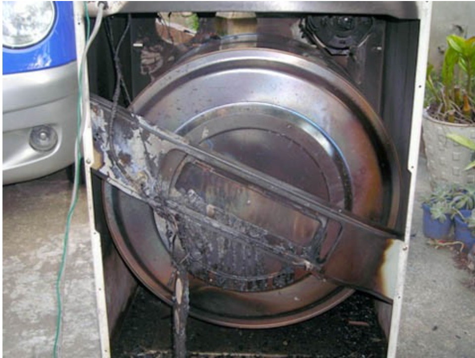
圖 5：滾筒後方，滾筒受燒較機殼嚴重。
