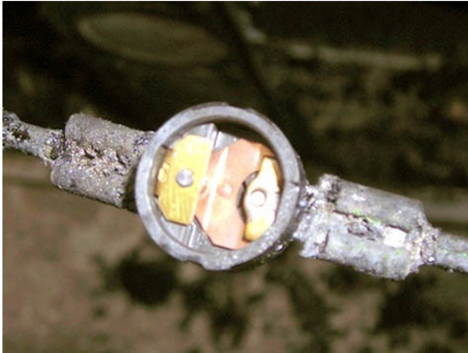
圖 7：過載保護開關僅外殼受熱，內部完好。
