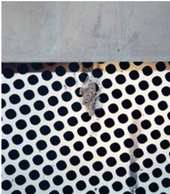
圖 6. 烘衣機之燃燒室與滾桶中間濾網(面向燃燒室一側)有燃燒殘餘物附著。
