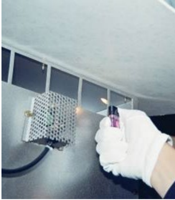
圖 7.燃燒室之進風口發現並無濾網或防阻異物侵入之構造。
