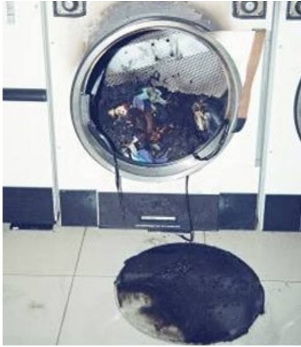
圖 3. 火災造成自助洗衣店烘衣機及內部衣物受火熱不等程度之燒損。
