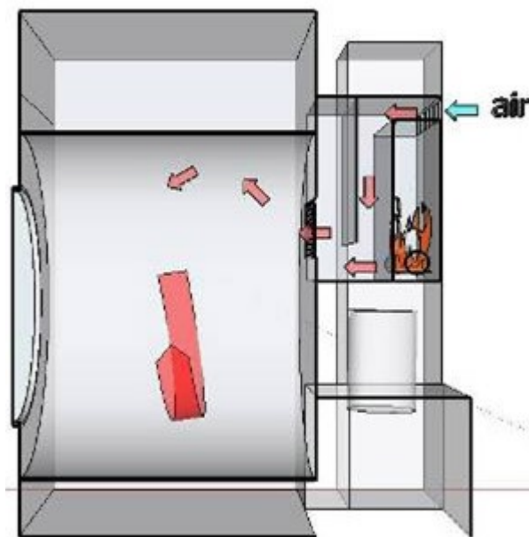
圖 2. 瓦斯燃燒產生之熱能使空氣升溫，加熱後之熱空氣經由風扇馬達送至滾桶內。
