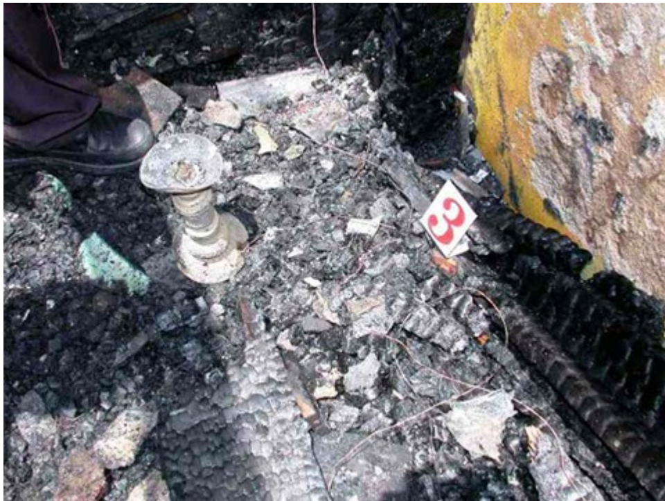
圖 4：神明燈及電源線嚴重燒毀掉落。
