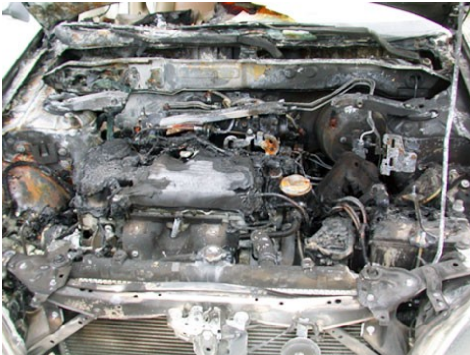
圖4 自小客車引擎室受燒後情形
