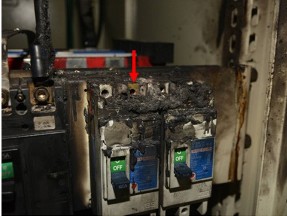
熔線斷路器 1 接點有受燒變色情形。
