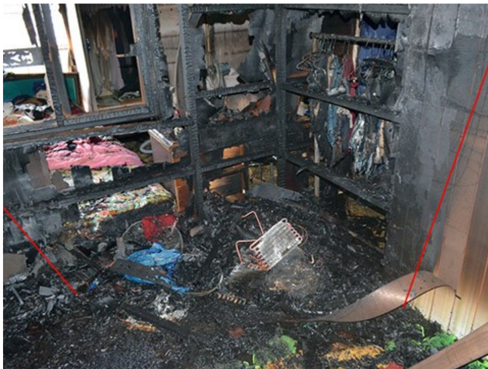
圖 3：觀察「臥室二」內燃燒後之狀況，可發現係以地板燒毀之除濕機為中心向四周擴大延燒。
