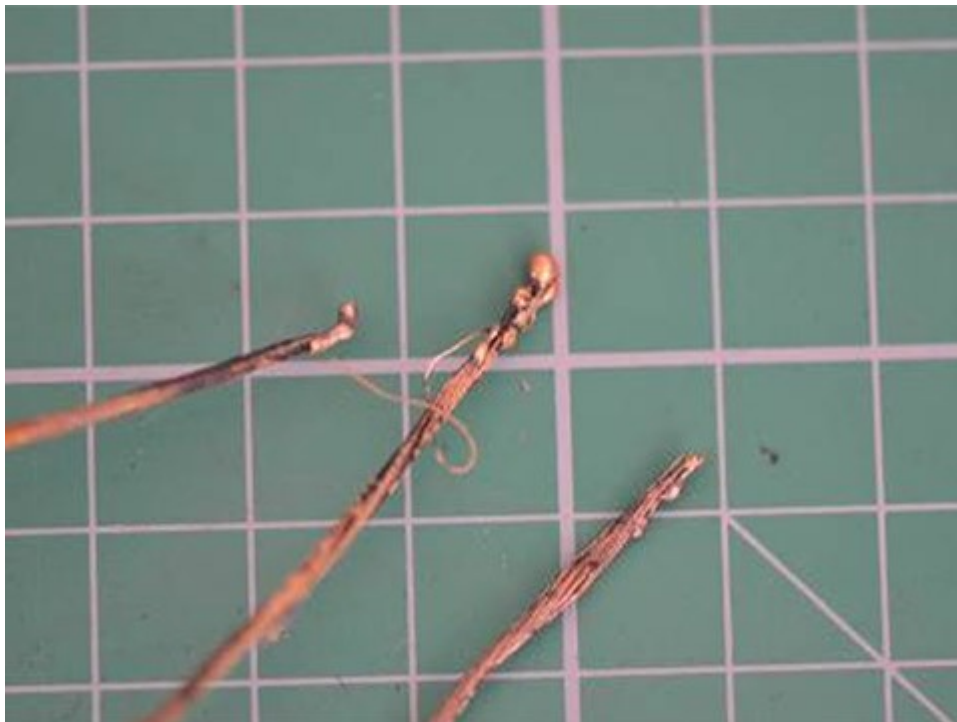
圖6：拍攝該除濕機電源線短路痕跡，該短路熔珠巨觀呈現導體局部熔解固化（及固化區外芯（股）線線條明確）之短路痕特徵。
