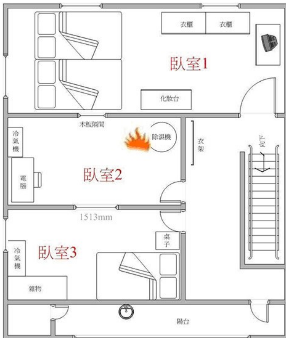
圖1：火災戶2樓平面配置圖及起火位置。
