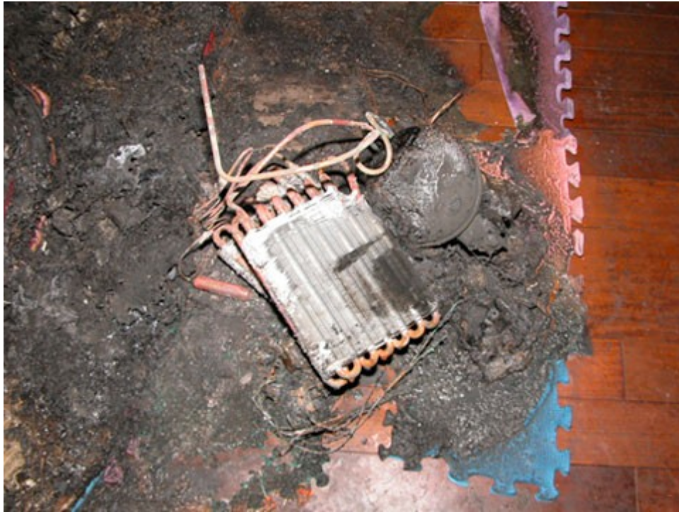
圖 4：冷凝器及壓縮機上方受燒較嚴重，塑膠地墊左側成圓形擴散。
