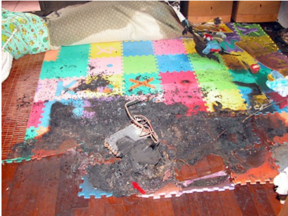
圖 2：移開棉被除濕機受燒情形。
