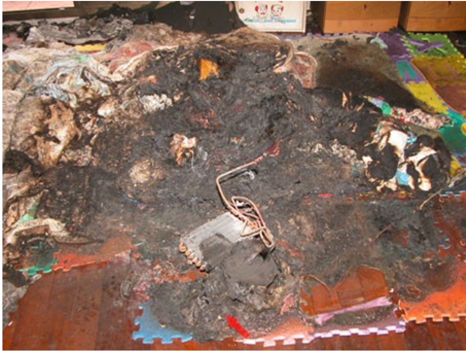
圖 1：除濕機與棉被受燒情形，紅色箭頭所指為電線熔痕處。
