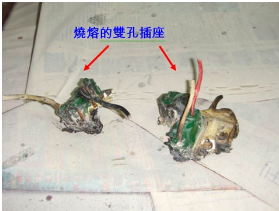
圖 5：燒熔的雙孔插座。
