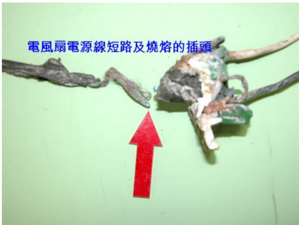
圖 6：電風扇電源線短路及燒熔的插頭。
