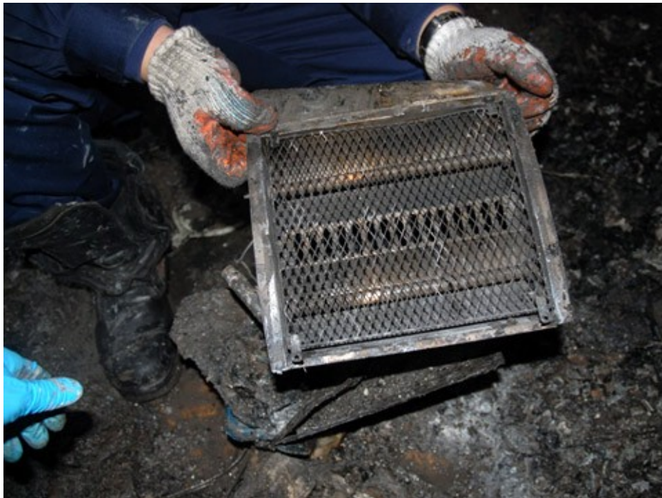
圖 5. 電暖器鐵質外殼及保護網變色。
