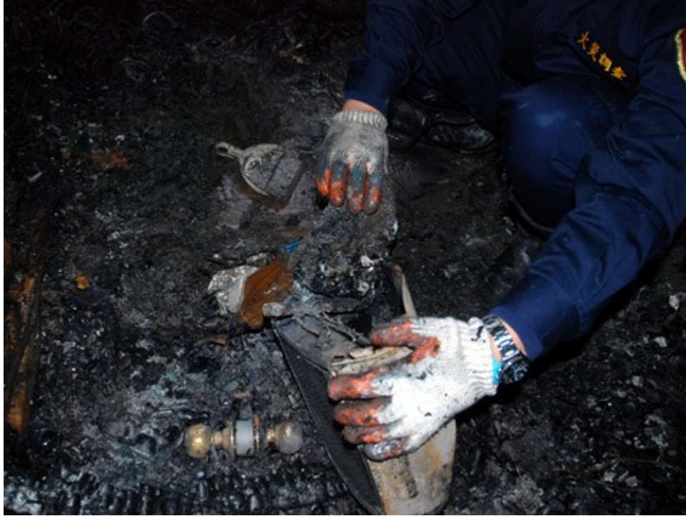
圖 6. 電暖器鐵質外殼底部保有原（藍）色，並殘留滅火器乾粉粉末。
