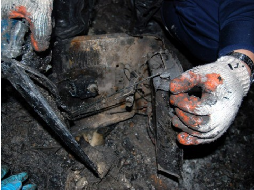
圖 4. 電暖器鐵質外殼內部上半部變色泛黃，下半部泛黑，電源銅線無短路熔痕。
