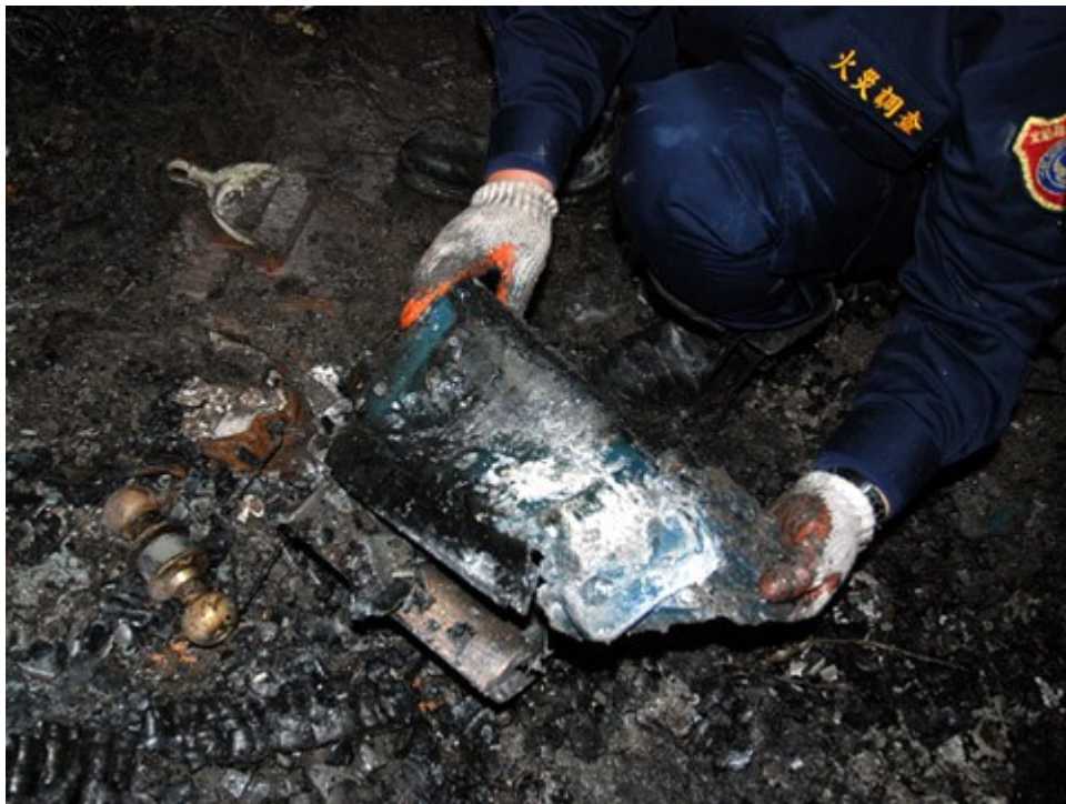
圖 3. 電暖器北側邊緣附著棉被碳化物。
