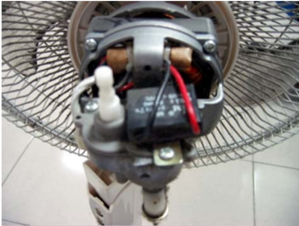
未受燒電風扇馬達配置情形（黑色為電容器）
