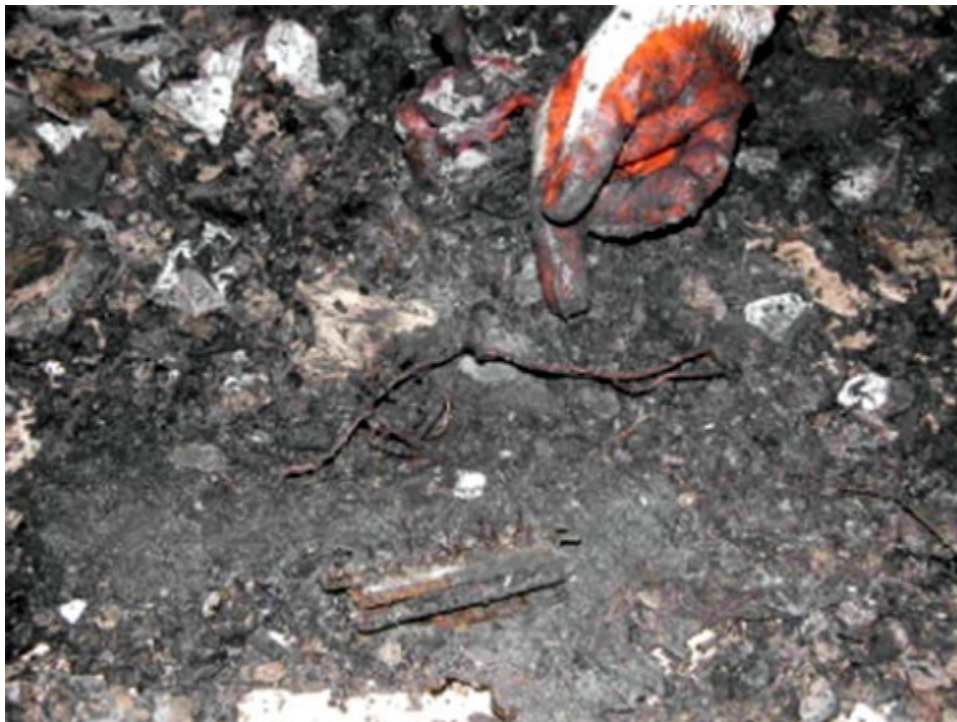
起火處挖掘出電風扇馬達、短路痕電線、風扇開關
