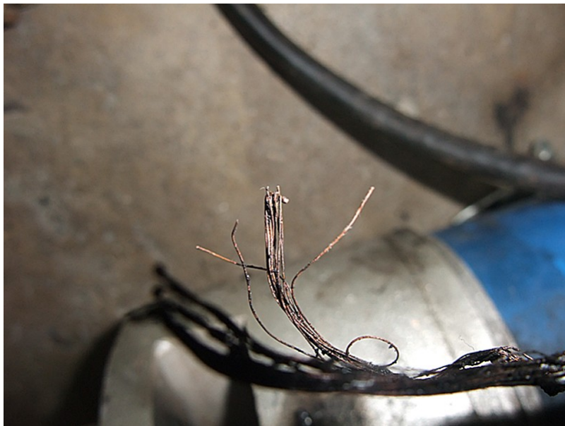
圖 3：線路出現短路熔珠
