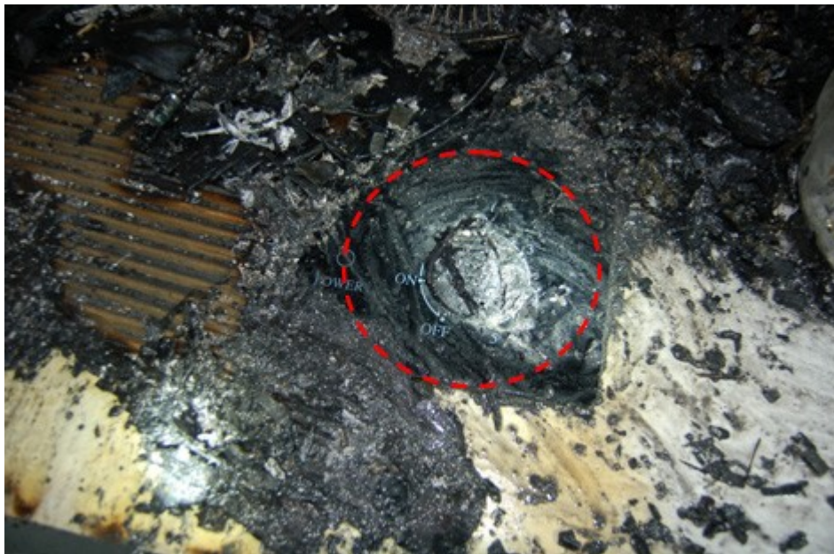
圖 3. 檢視電陶爐面板加熱開關呈開啟、加熱狀態，拆卸旋鈕其旋轉至 5 狀態。
