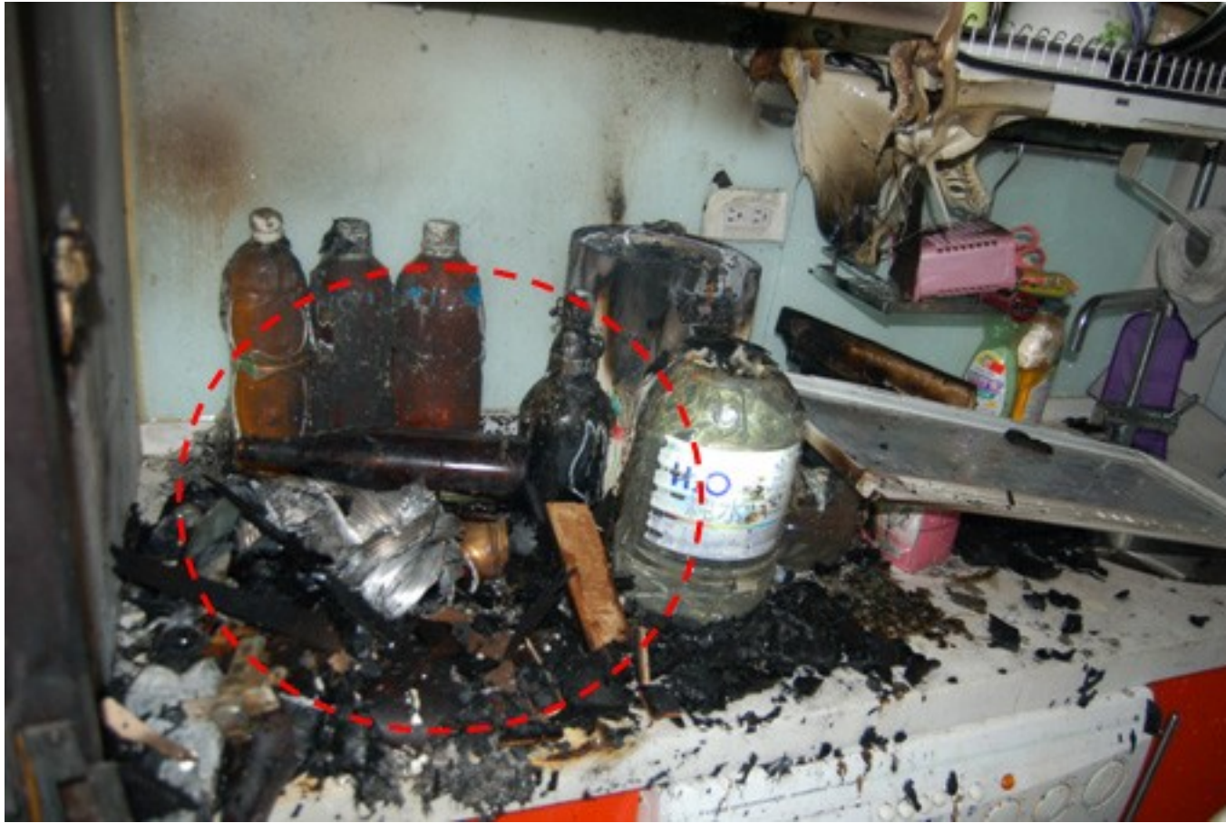
圖 2. 廚房之廚具物品以電陶爐面板處之紙箱受燒失較嚴重。
