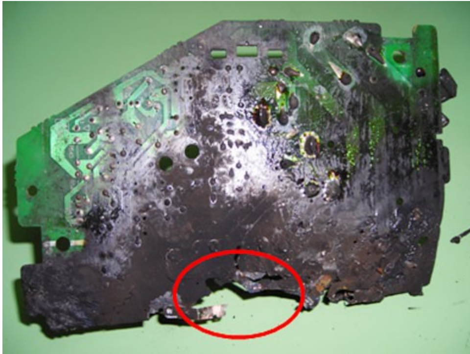
圖9：偏向基板接線端子處燒失（反面）。
