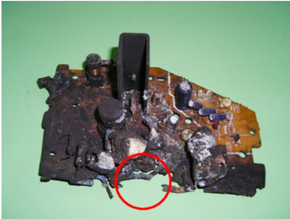
圖 7：偏向基板接線端子處燒失（正面）。
