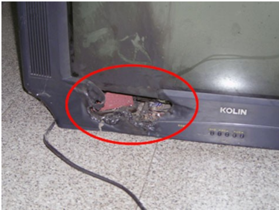
圖 2：電視機右下角塑膠燒熔。
