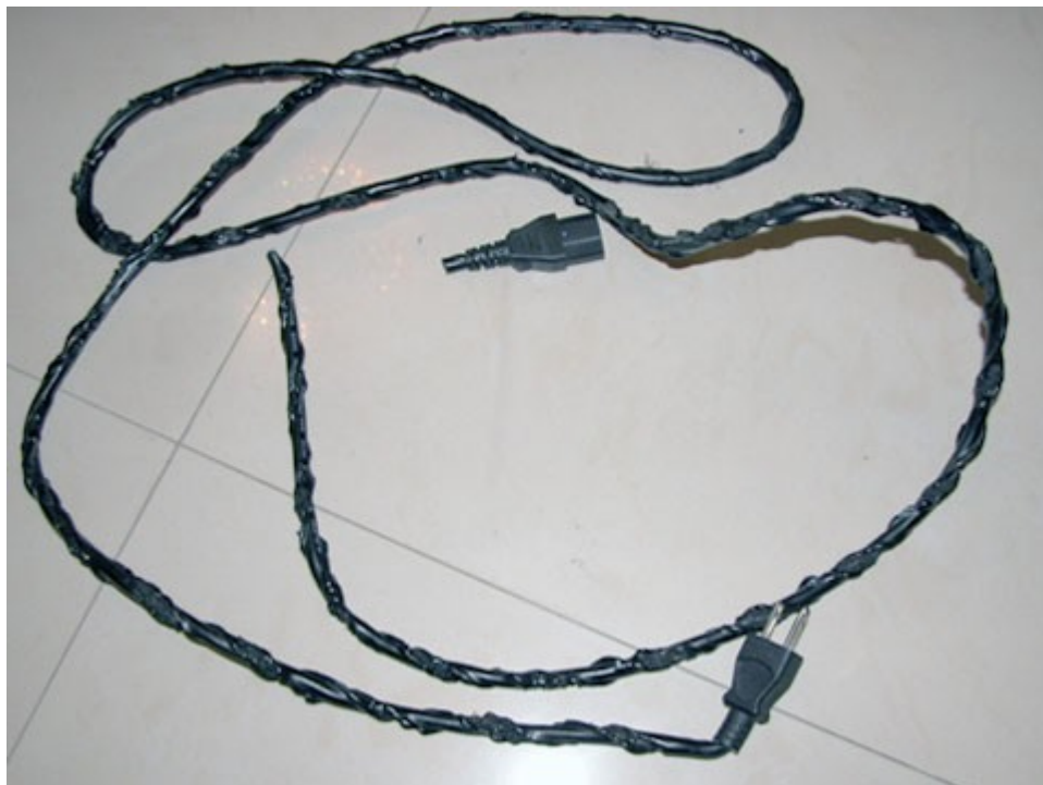
圖 3：電源線受燒情況（電源線為調查人員所剪斷）。
