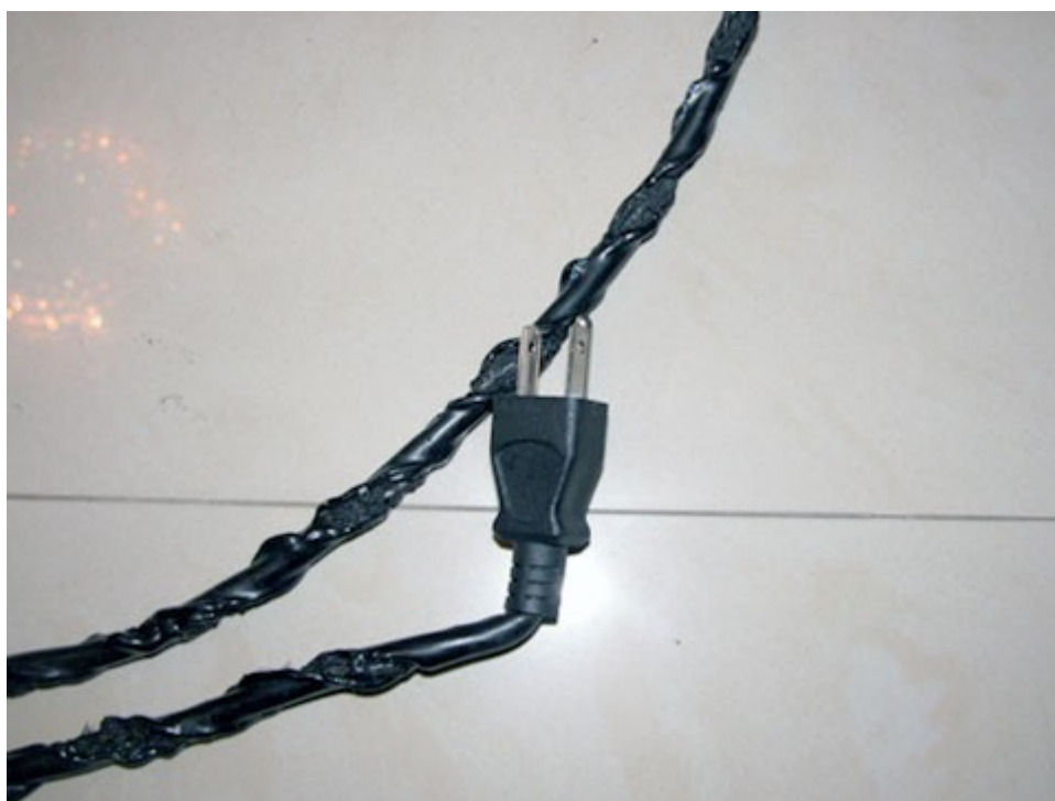
圖 4 - 1：電源線受燒後近拍，受燒地線呈螺旋狀。
