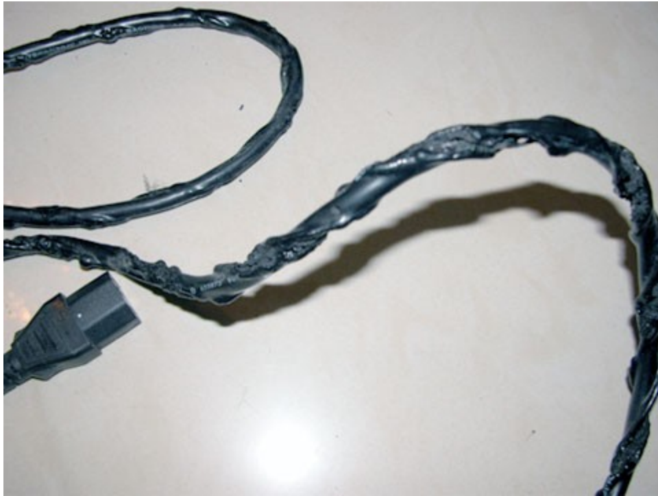
圖 4-2：電源線受燒後近拍，受燒地線呈螺旋狀。
