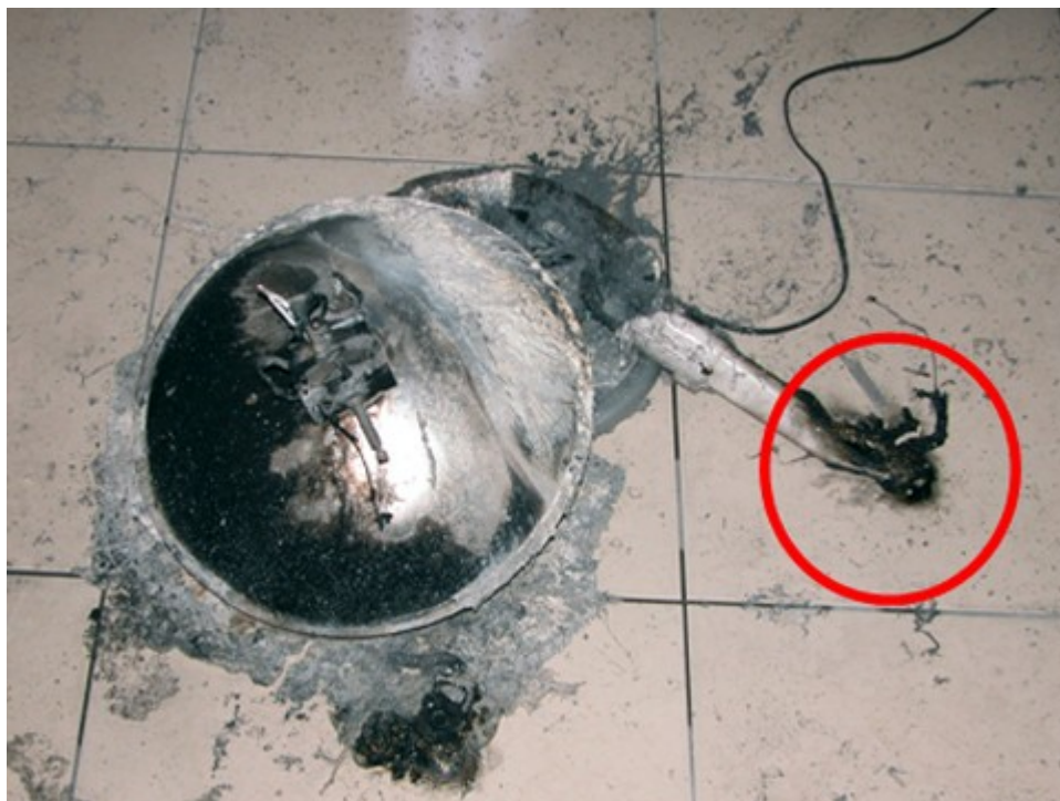
圖 1：起火電暖器受燒情形--加熱部掉落、前護網蓋在底座上方，紅色圈起處為該電暖器起火處。
