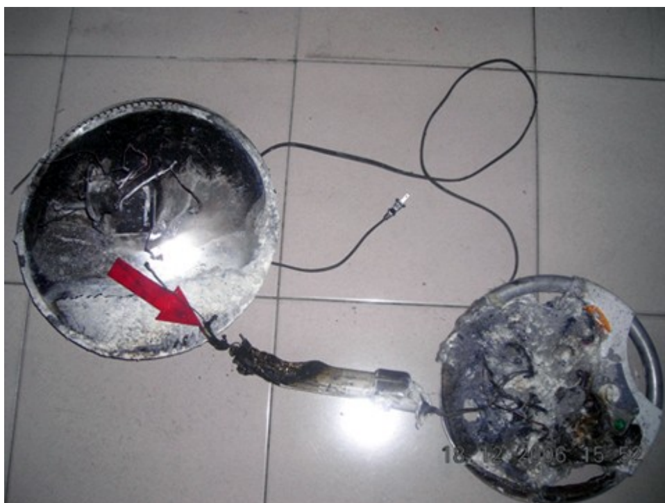
圖 3：箭頭所指處為伸縮桿燒熔部位電線熔痕，也就是圖 1 的紅色圈起處。
