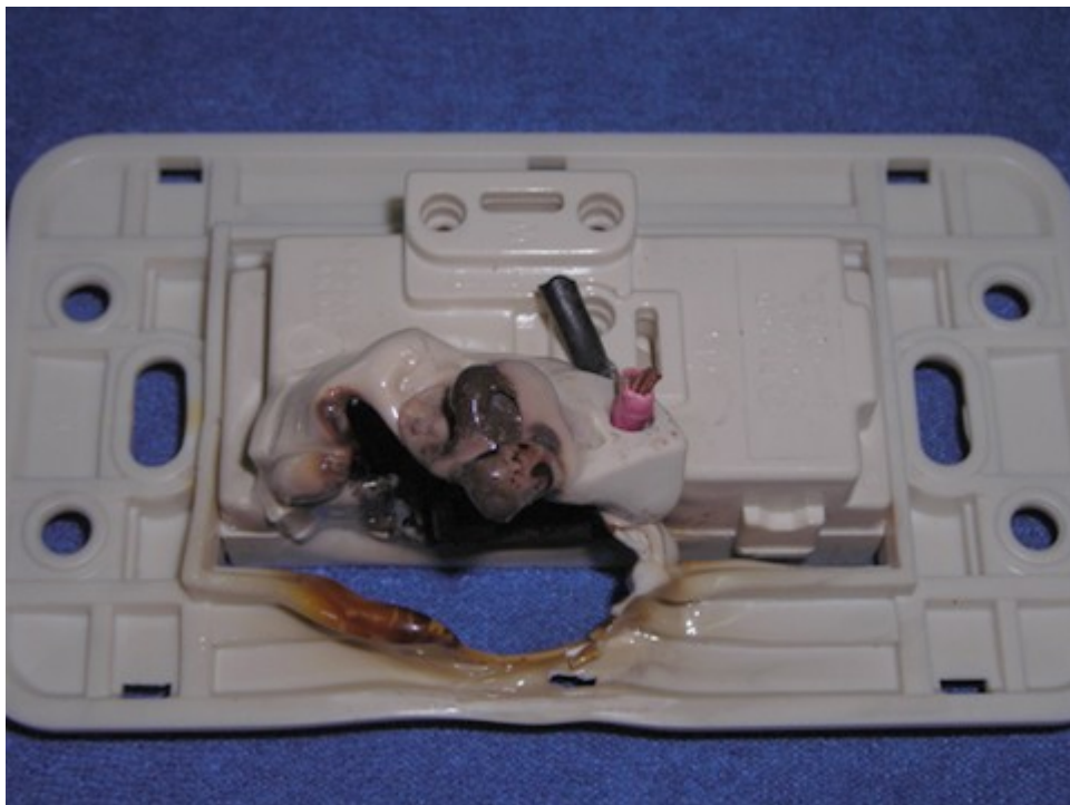
圖 2：燒熔插座後面。
