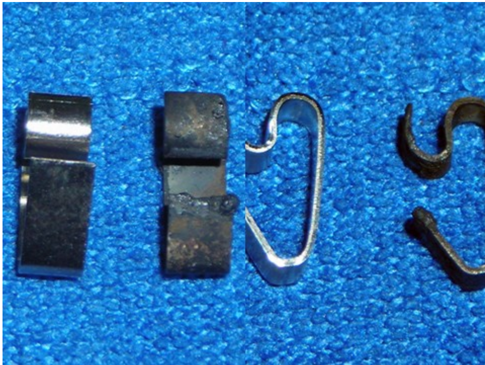
圖 4：插座內簧片（左側為正常，右側為燒熔簧片）。
