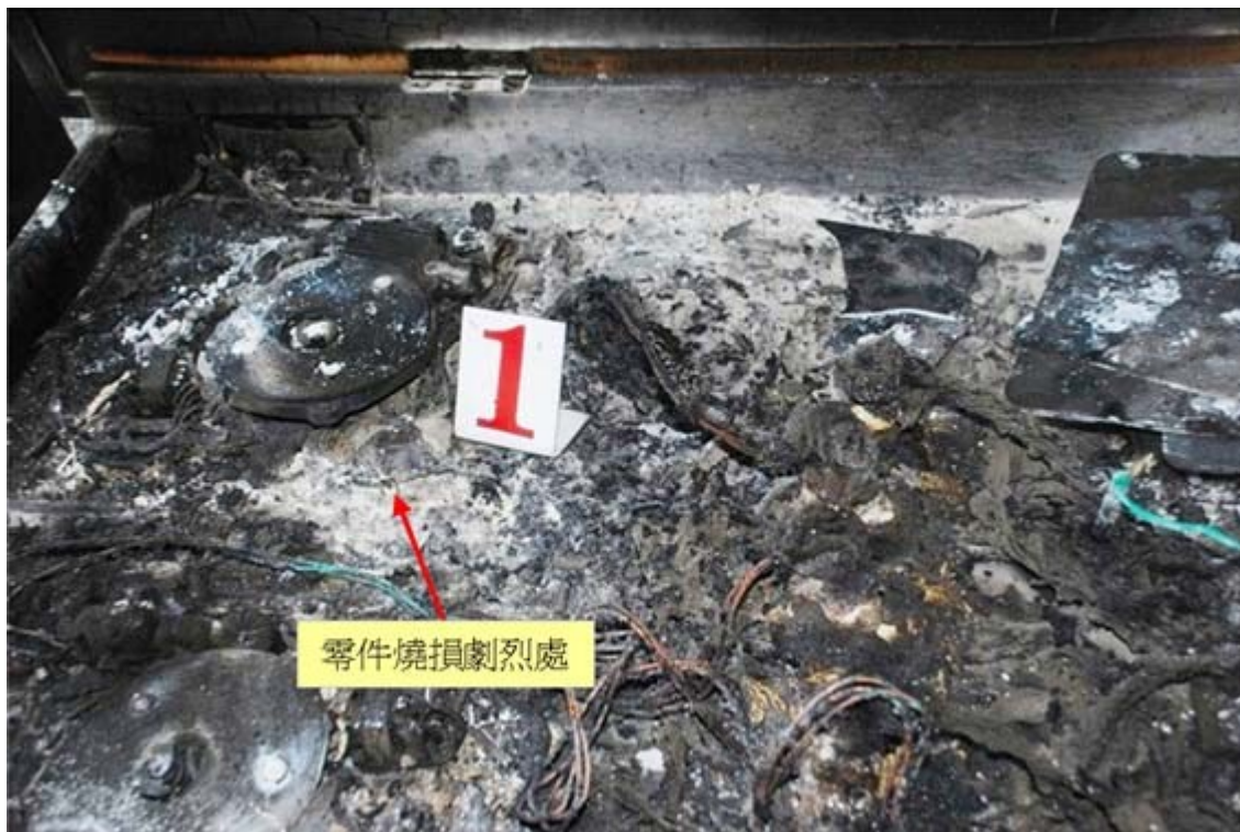
圖 8：電磁爐（編號 1）擺放處，電子零件呈現受火勢劇烈。
