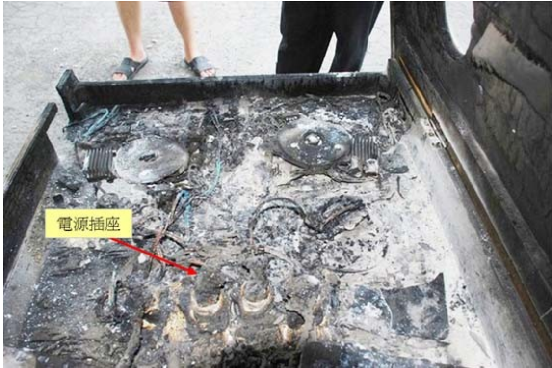
圖 7：檢視電磁爐內電源線及電源插座僅受火勢高溫燒損，未發現有通電短路痕跡。
