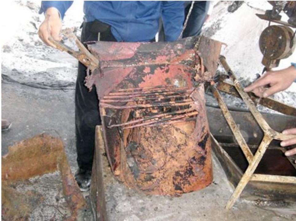
圖 3：檢視螺旋式靜電消除器並比對同型樣品，發現靜電消除器位於桶內部分嚴重受燒毀
