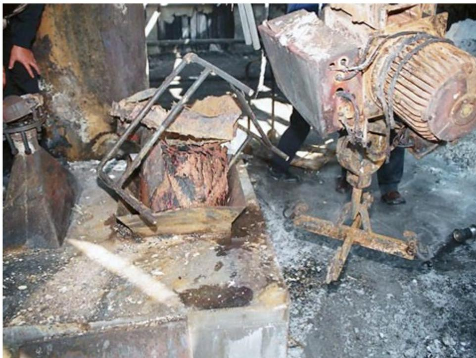
圖1： 勘查時位於 AT05 之 # 2 號桶上方之天車有吊掛支撐太空包鐵架，下方 # 2 號桶口有置放承接鐵架及螺旋式靜電消除器，地面散落大量改質劑，顯示當時有吊掛太空包卸料作業
