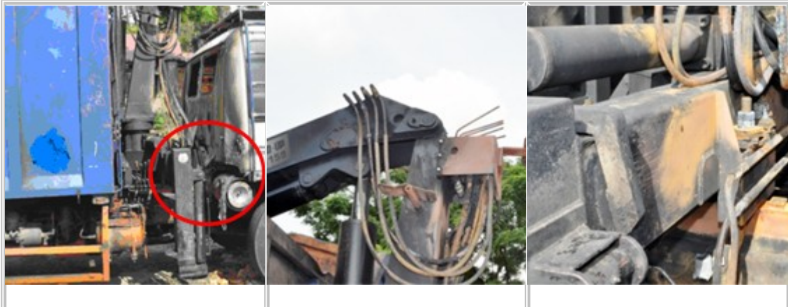
圖 1：駕駛室及吊桿間下方起火
