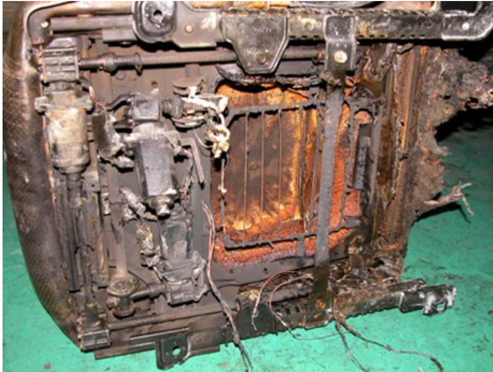
圖 5：駕駛座下方電動馬達燻黑，泡綿表面燒熔。
