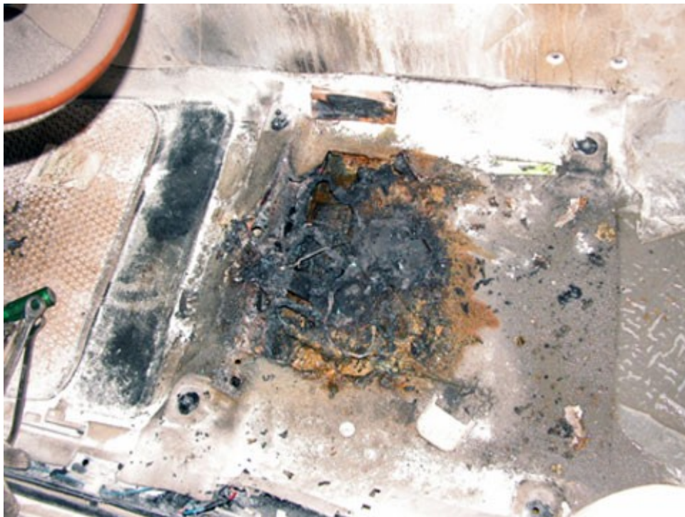
圖 8：駕駛座移開後情形顯示線束位置受燒嚴重。
