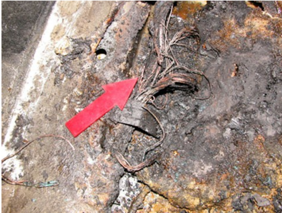
圖 9：塑膠端子燒失，箭頭所指為電線熔痕。
