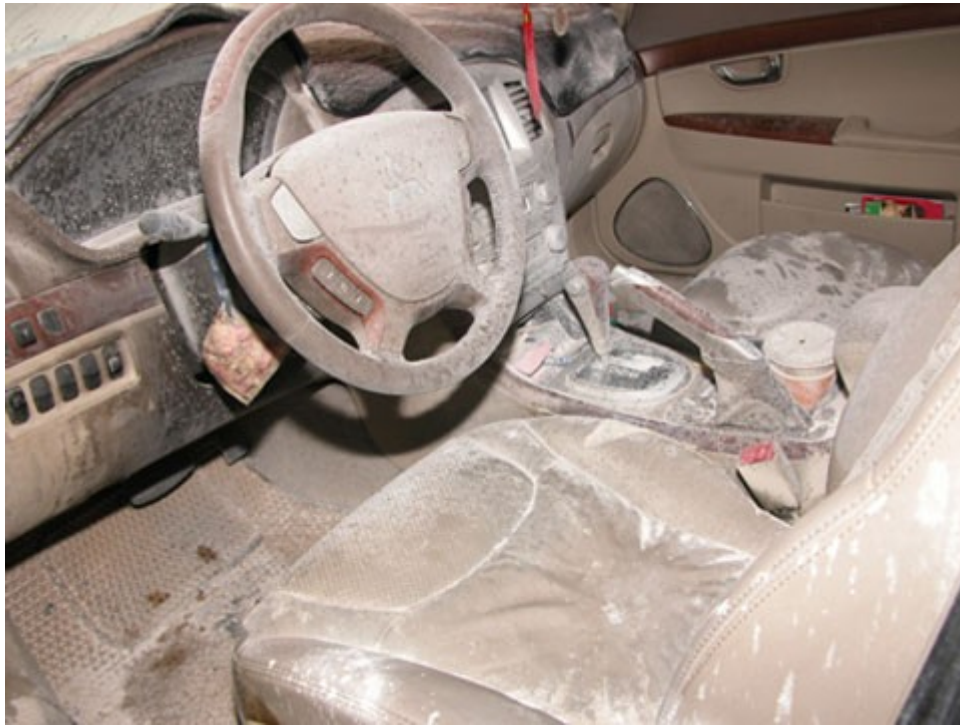
圖 1：汽車駕駛座，皮椅表面受燒變形。
