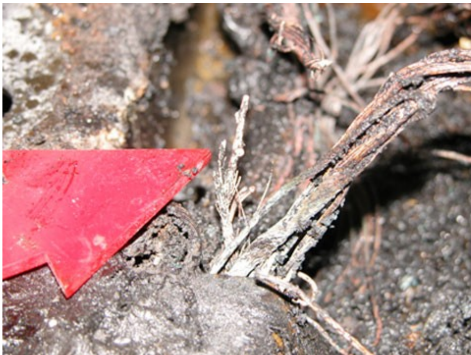
圖 10：箭頭所指為電線熔痕。
