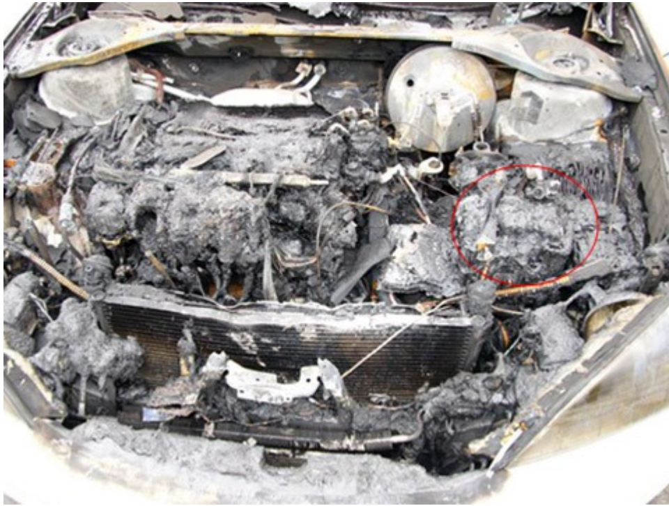
圖 1：起火處位於左側空氣濾清器及電瓶受燒毀。
