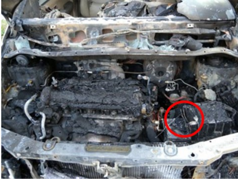
圖 5：引擎室內受燒情形，紅圈處受燒嚴重。
