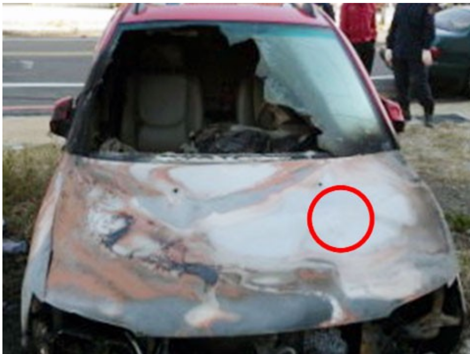
圖 2：車體前側，引擎蓋紅圈處受燒嚴重。
