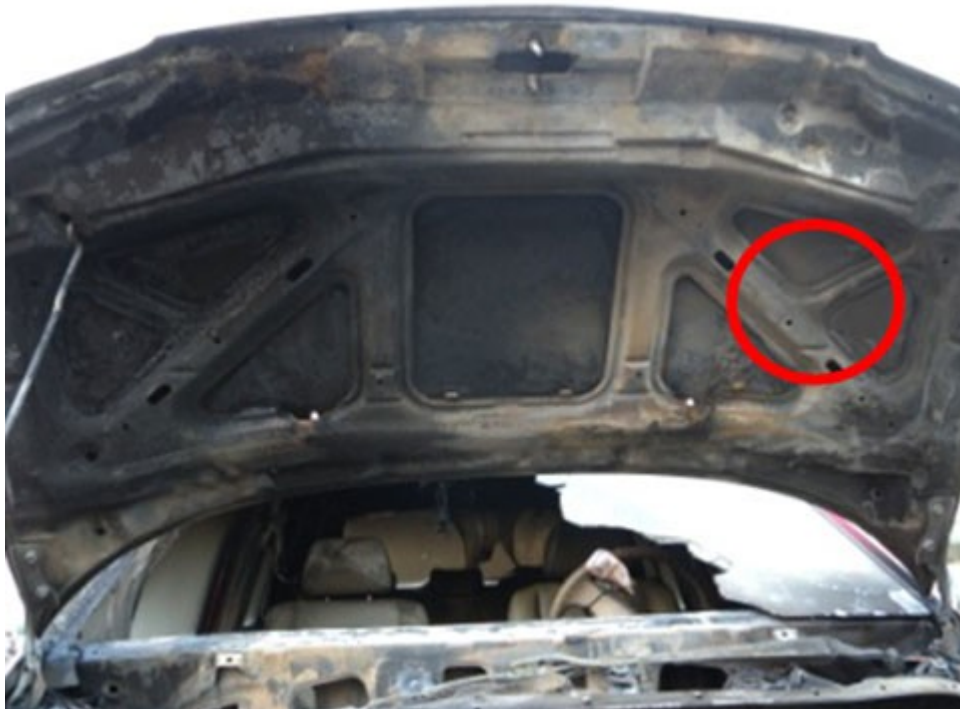
圖 4：引擎蓋下方，紅圈處受燒嚴重。
