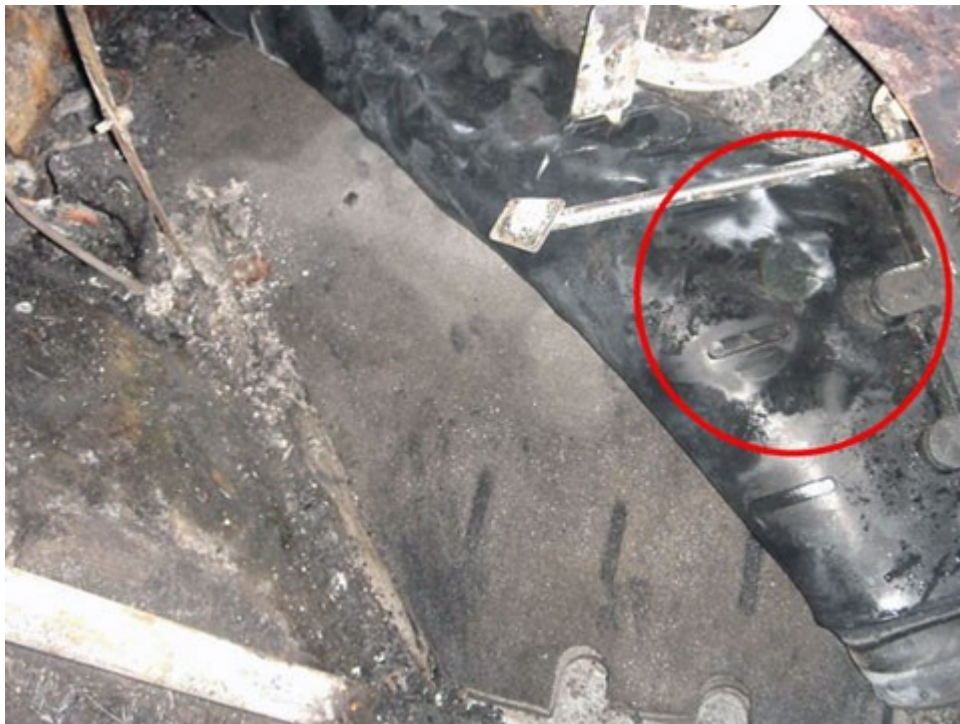
圖 3：翻開橡膠腳踏板背面，發現放鐵罐位置有輕微受燒熔。
