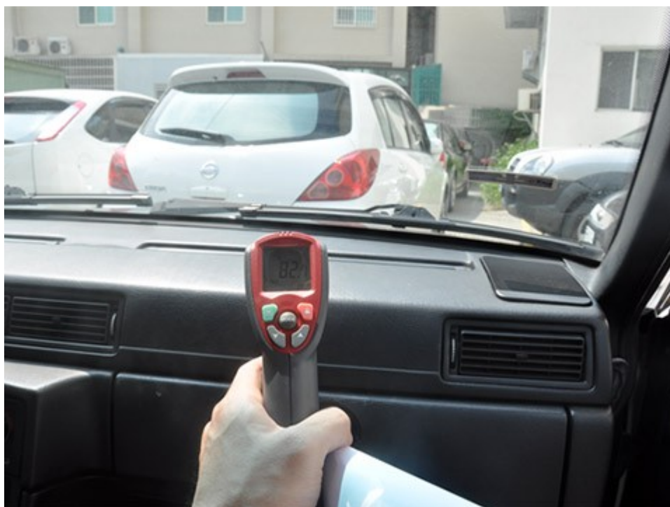
實測墨綠色車內無隔熱紙擋風玻璃下溫度高達 82.7 度。
