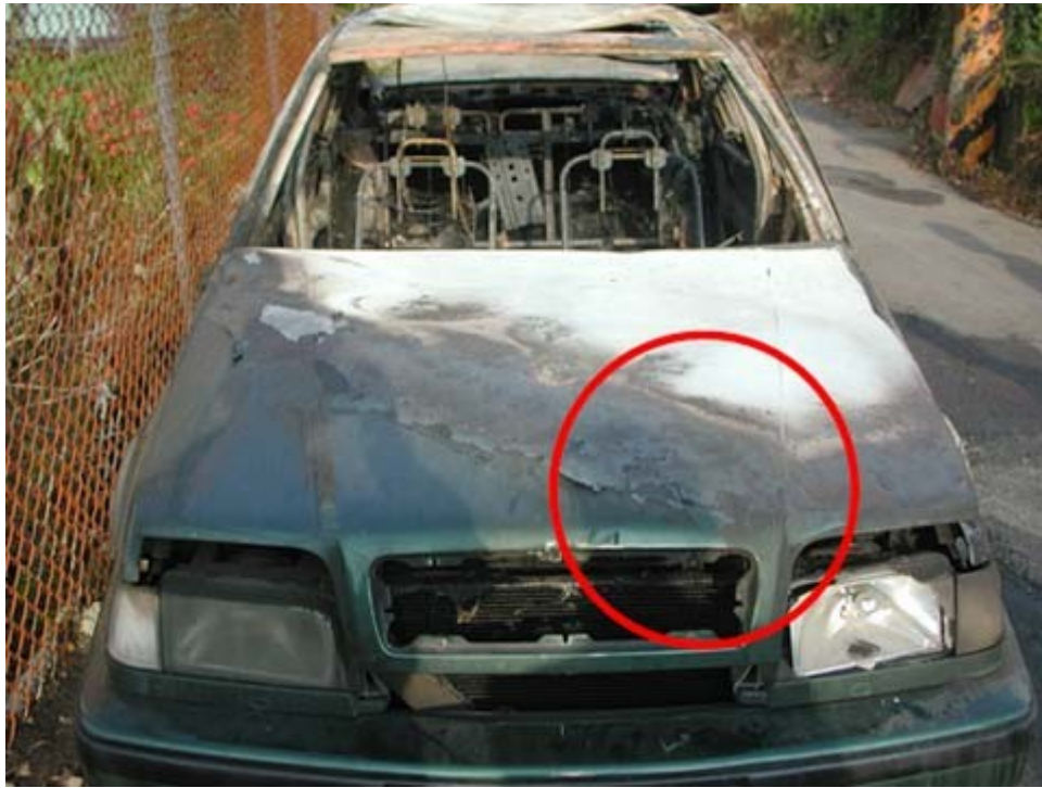
圖 1：起火車輛引擎蓋內側受燒泛白
