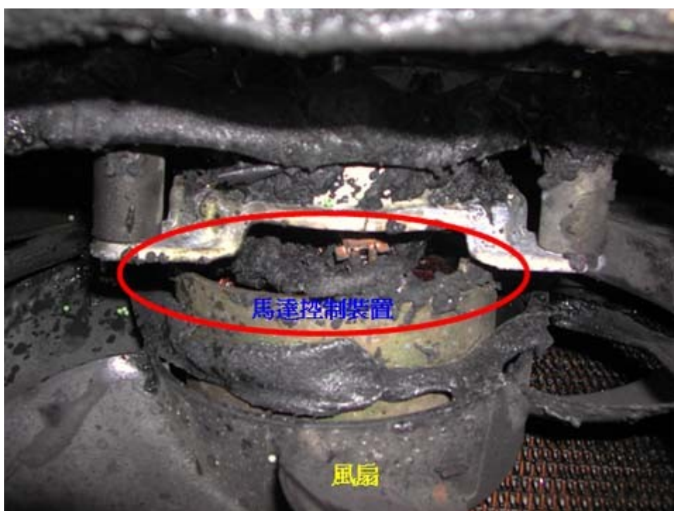
圖 5：馬達軸承受燒燻黑、碳刷元件燒熔
