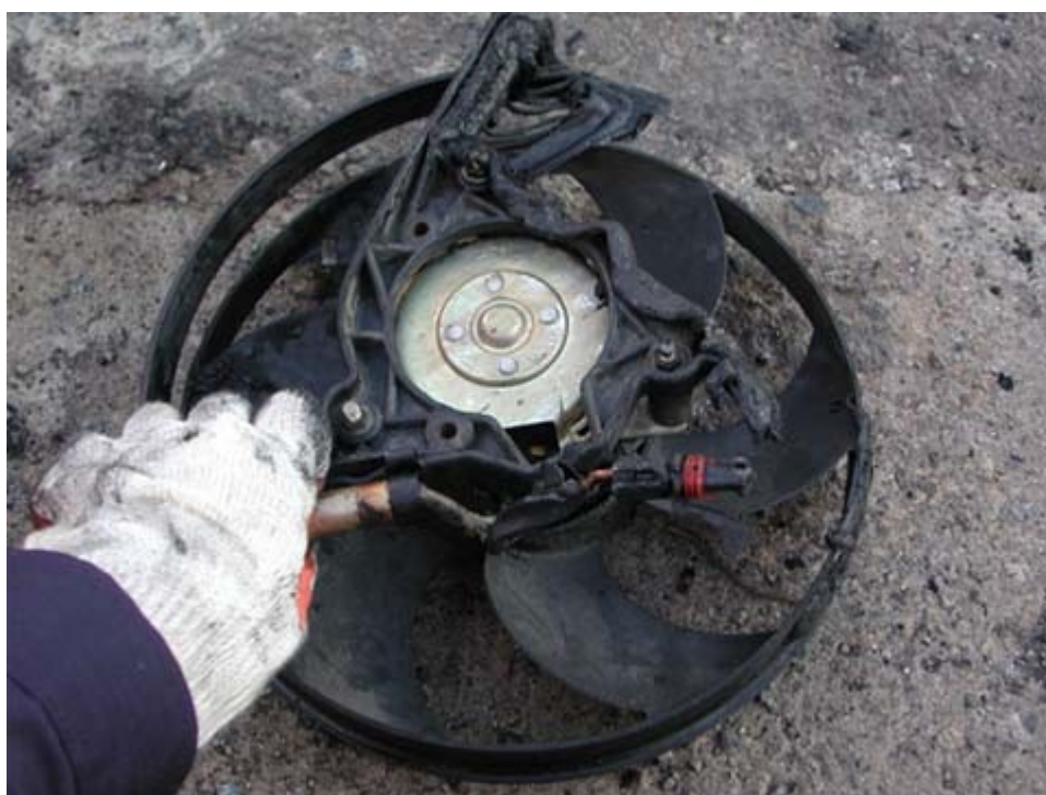
圖 6：風扇馬達裝置，扇葉端未受燒，控制裝置端部分燒熔
