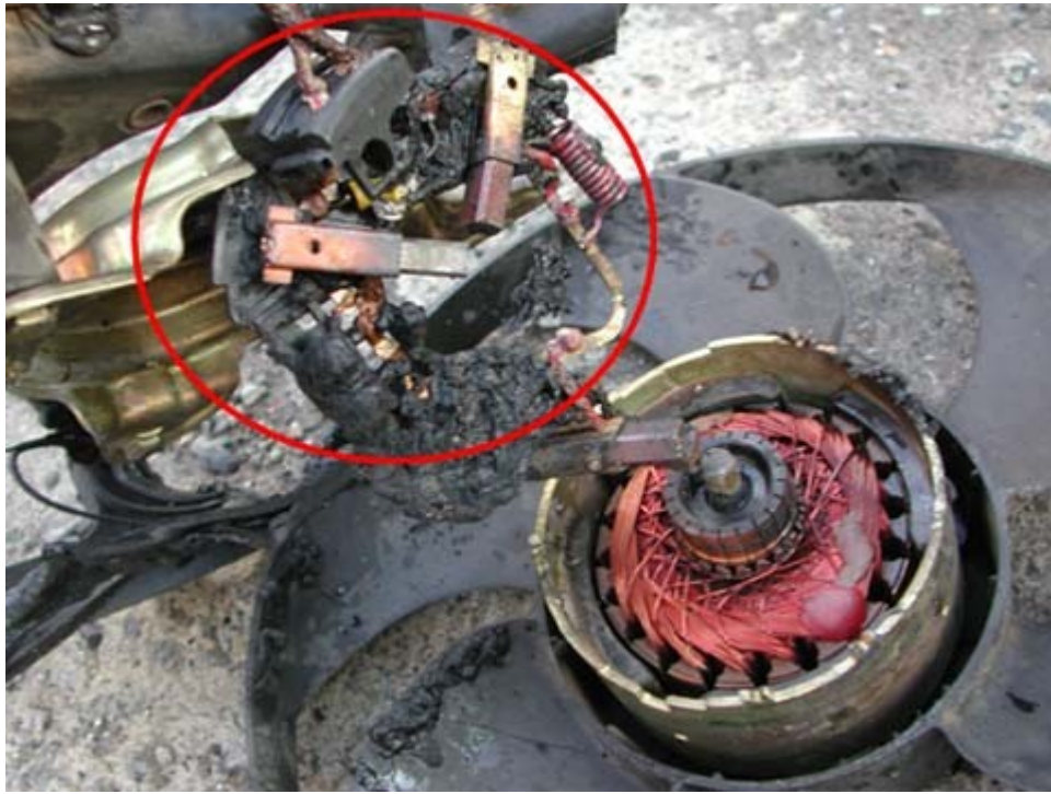
圖 7：馬達控制裝置受燒情形
