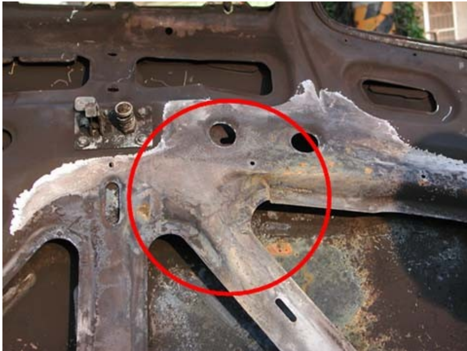
圖 2：引擎室延燒方向
