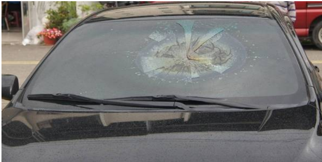
圖 1：前擋風玻璃靠中間位置有受燒裂痕。
