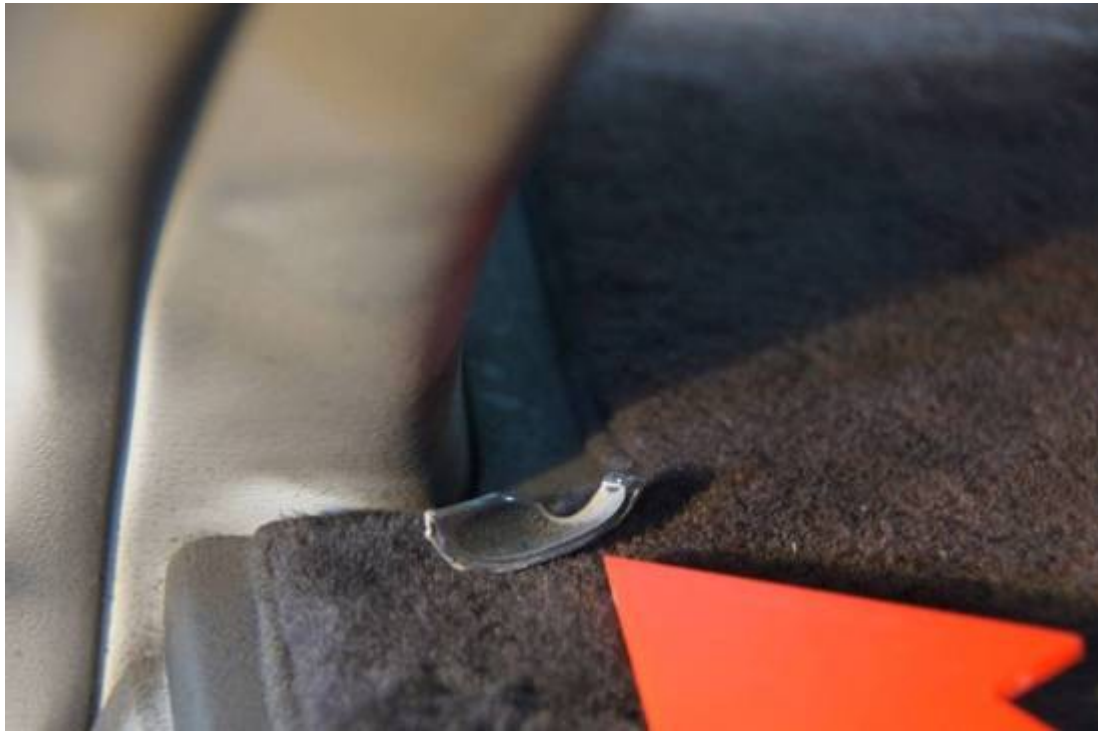
圖 5：駕駛座 A 柱旁發現打火機碎片。
