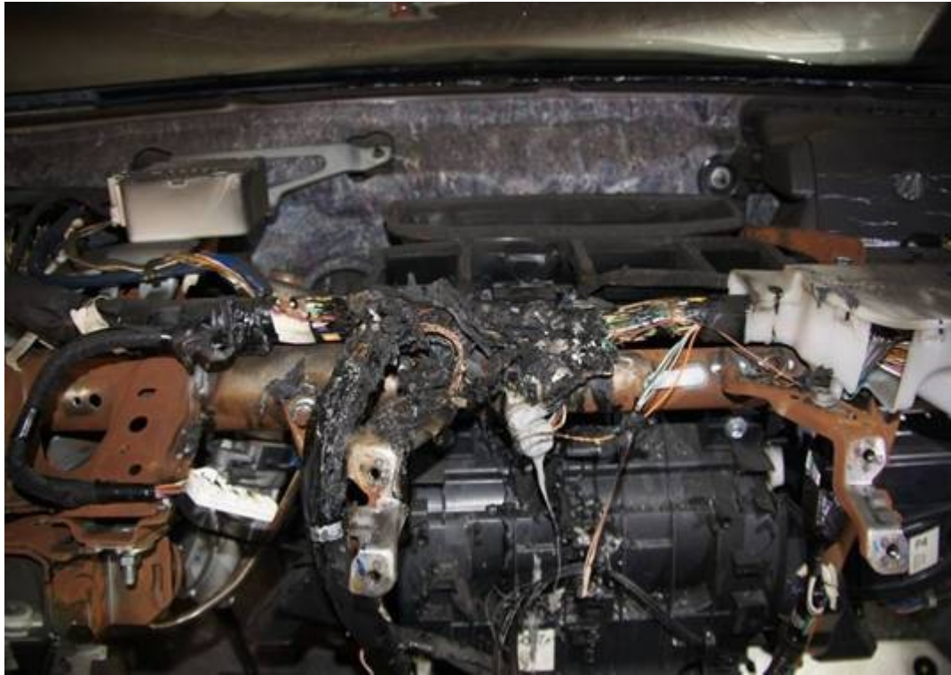
圖3：拆除儀表板外殼，檢視內部儀表板之電線束總成，發現電線被覆僅受燒熔並無短路痕跡。
