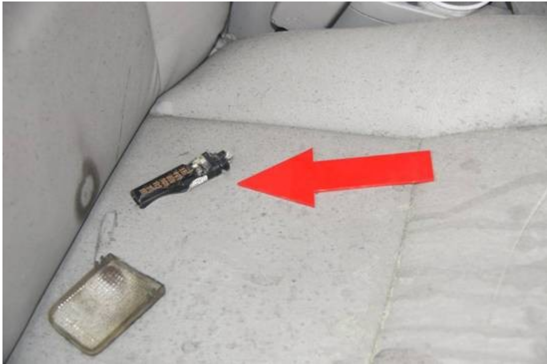
圖 4：於副駕駛座墊發現 1 只爆裂打火機。
