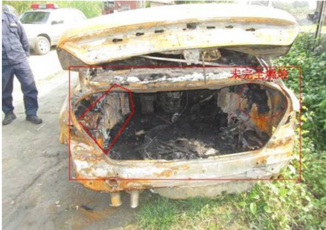
圖3：行李箱內部以左側端附近機件及板金受燒熔泛白情形較嚴重
