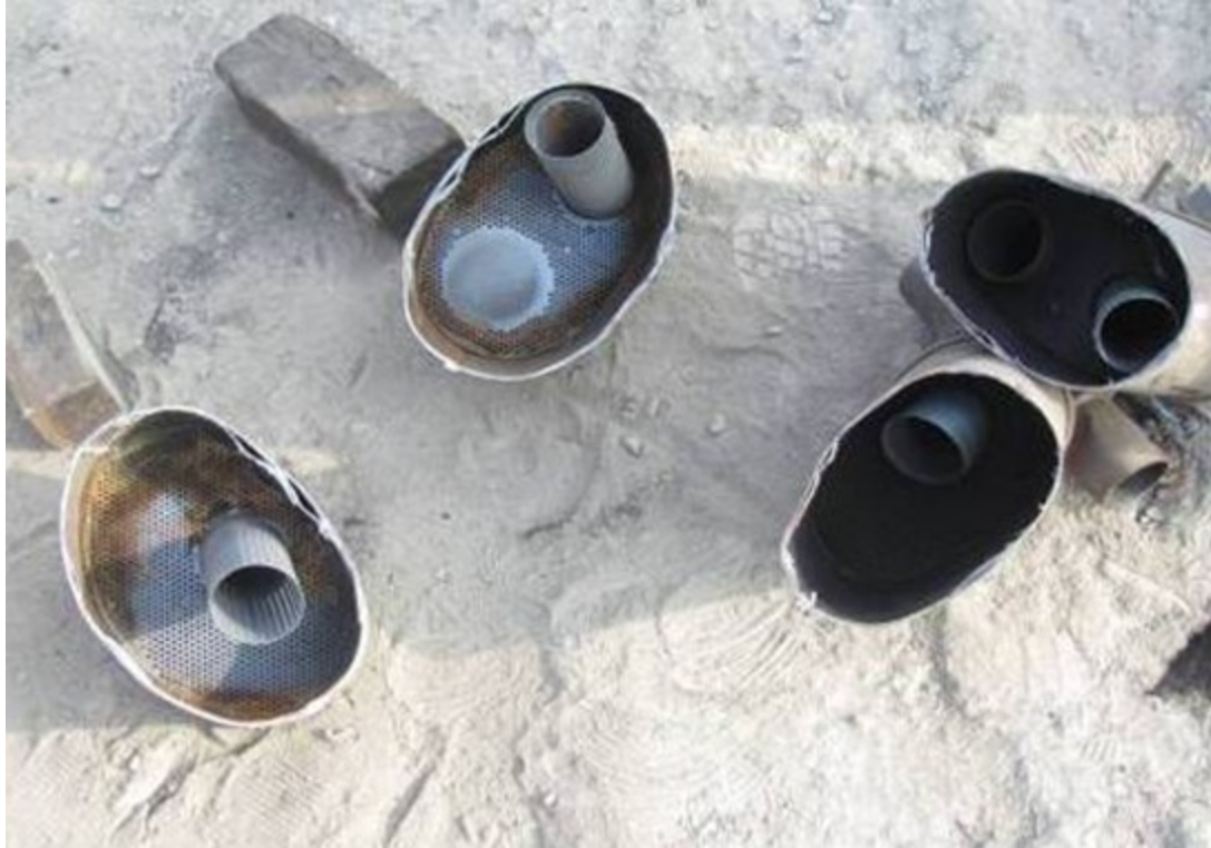
圖 5：後段排氣管消音器拆卸剖開，分別發現左側顆消音器內部金屬局部嚴重燒白呈金屬原色，右側顆消音器內部充滿黑色積碳情形
