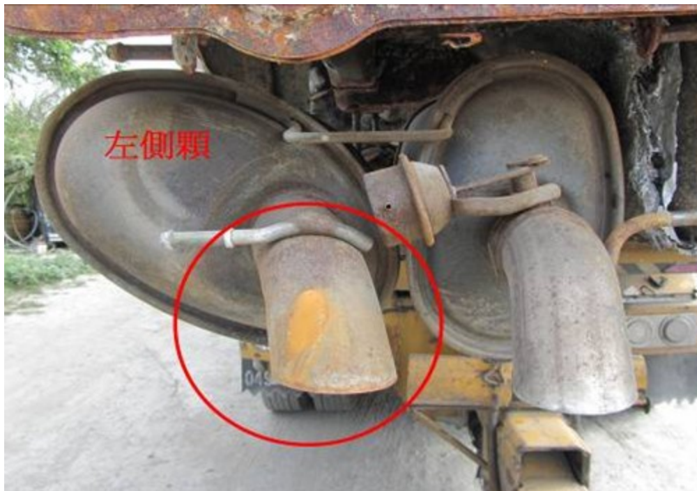
圖4：起火車輛後排氣管口嚴重變色燒紅情形
