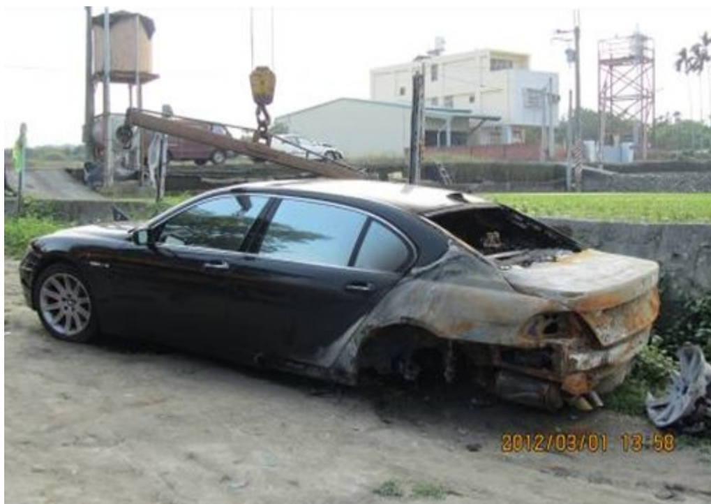
圖 1：受燒毀處僅侷限後行李箱、後兩側葉子片及左後輪胎受火勢嚴重燒毀變色情形，其他處均完好無受燒
