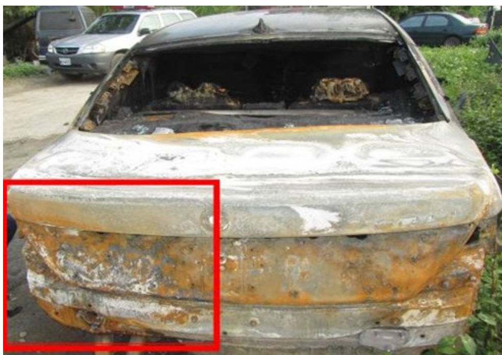
圖 2：左後保險桿（排氣管上方）附近板金受燒毀泛白情形最為嚴重
