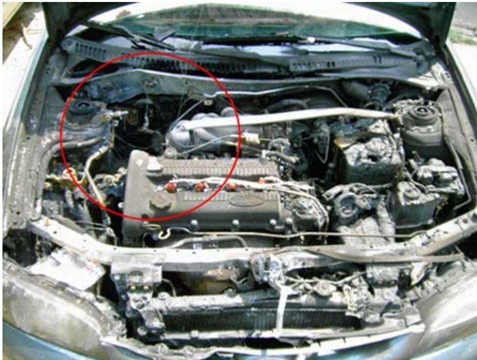
圖 1：起火車輛引擎室以車輛右側靠近擋風玻璃處受燒嚴重。
