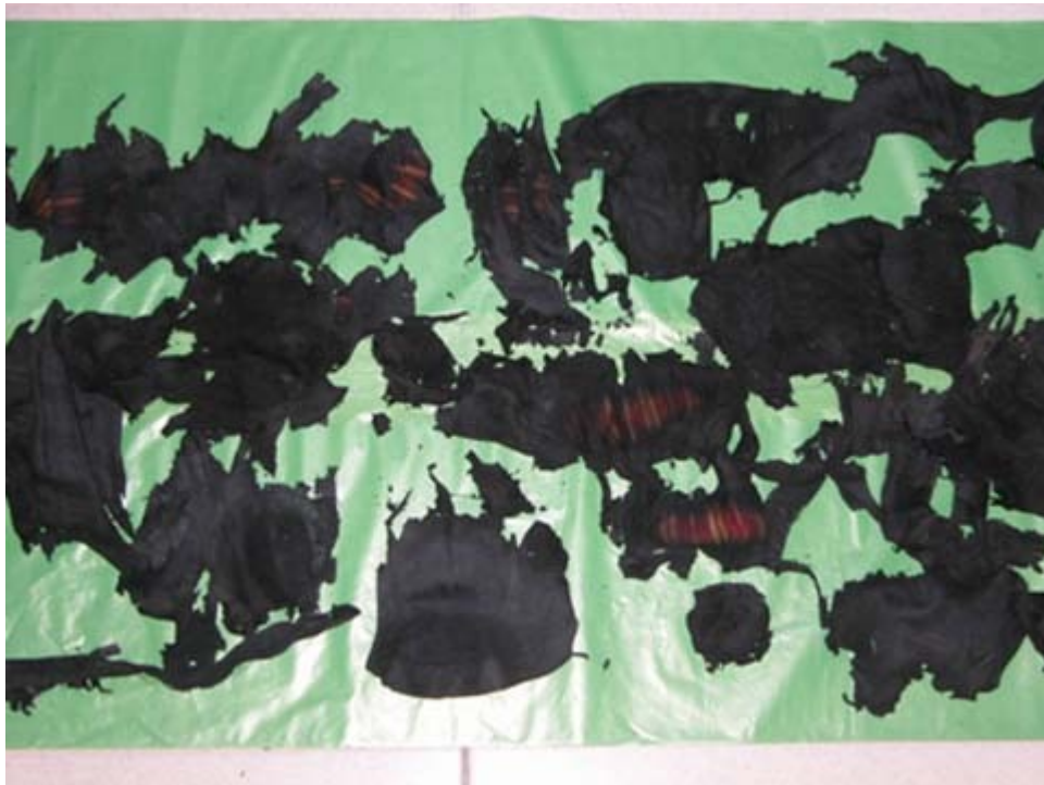
圖 3：排氣管上方殘渣展開後情形。
