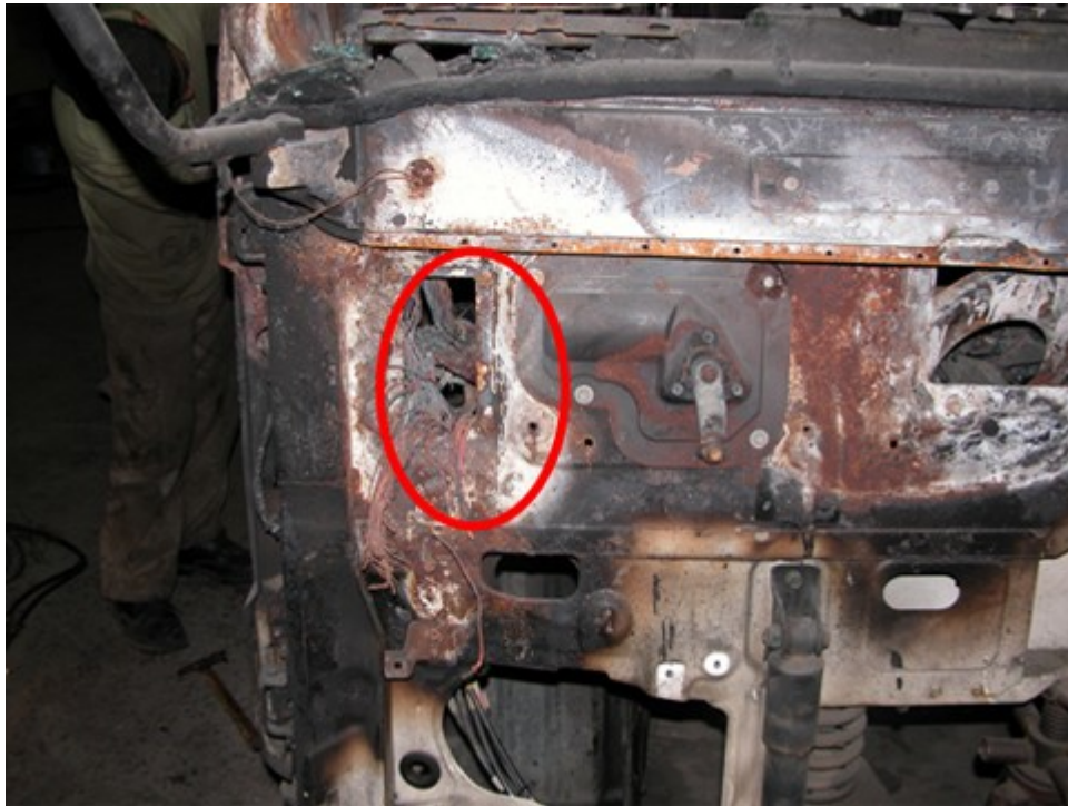
圖 2：相片 1 近拍，圓圈處為貫穿部開口，電線由駕駛座艙向下延伸至車體。
