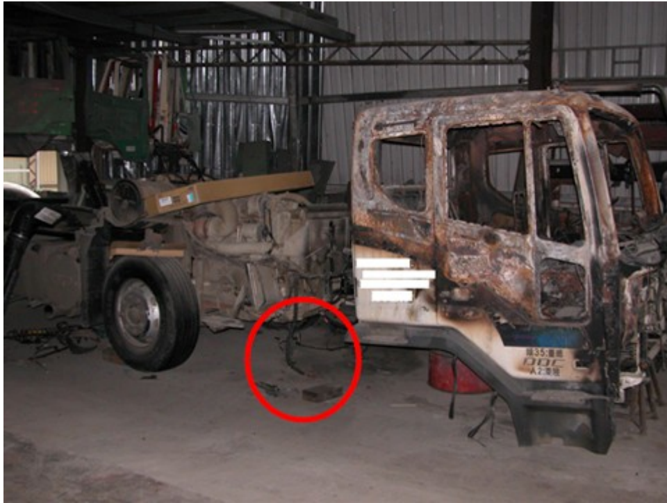
圖 4：車頭上方的駕駛座右前側下方受燒較嚴重，車頭下方的引擎部則完好，圓圈處為駕駛座內延伸至車體電路配線。
