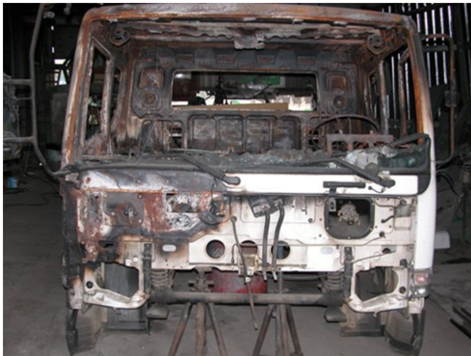
圖 1：起火車輛車頭右側下方受燒較嚴重。
