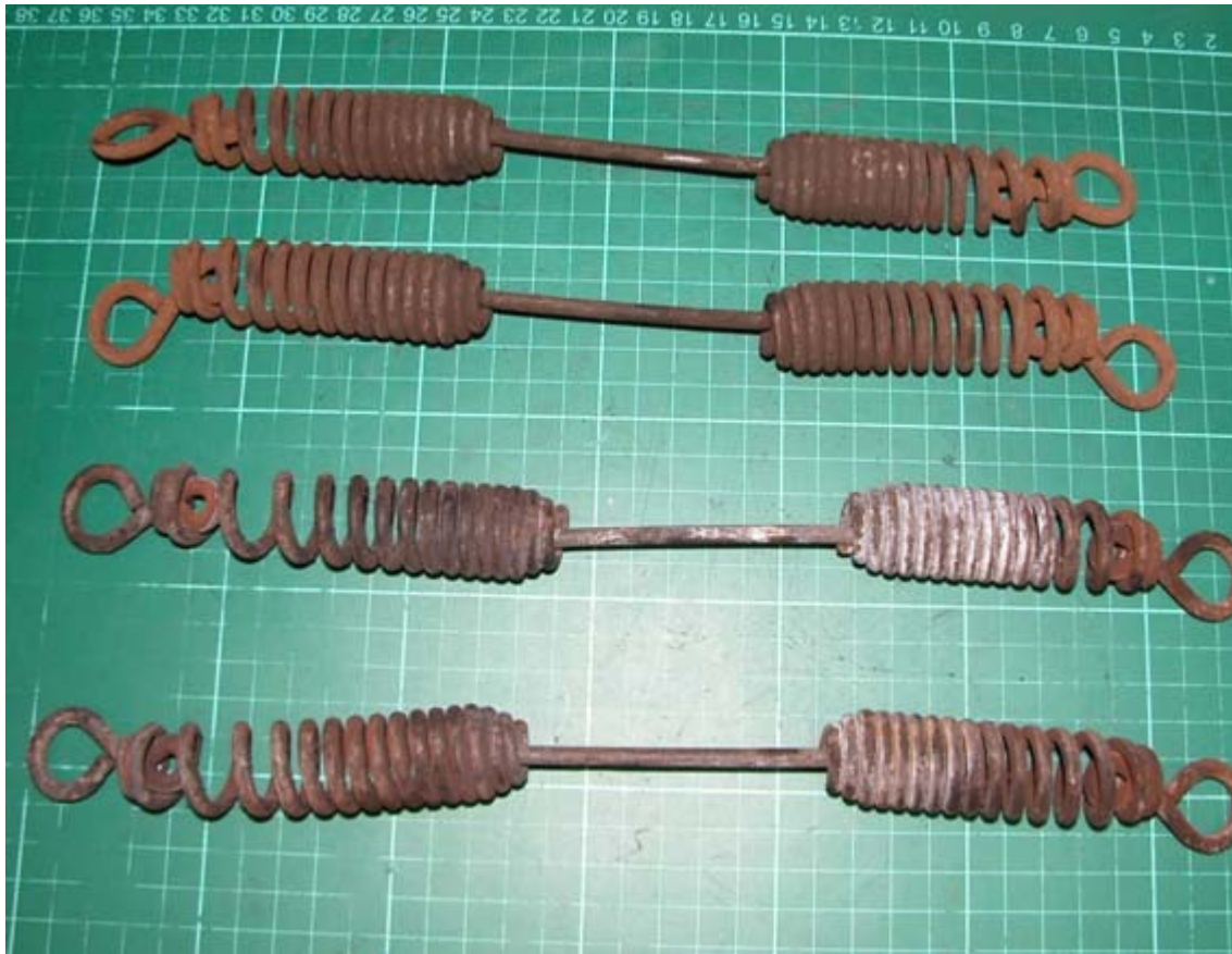
圖4：同車輪回拉彈簧受熱後變形、變長。
