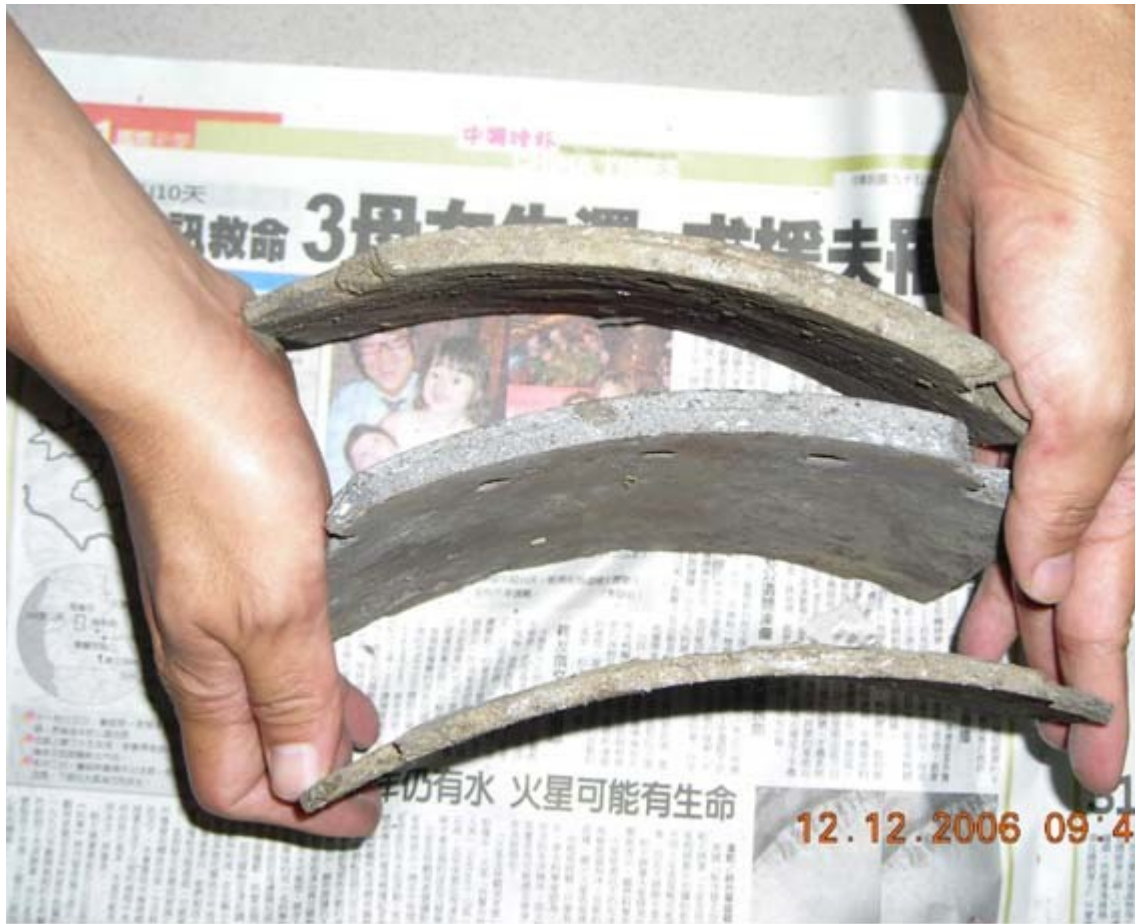
圖5：同車輪來令片厚度比較（上、下為磨損片）。
