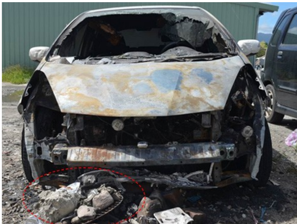
起火車輛前擋風玻璃受燒破損，引擎蓋受燒變色嚴重，車頭塑膠保險桿燒失；車輛右前方下方有土窯雞、烤肉架、木炭及磚頭等物（畫圈處）。
