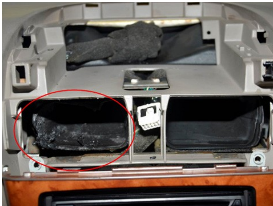
圖1：勘察自小客車內部，前座中間冷氣出風口左側輕微燒熔。
