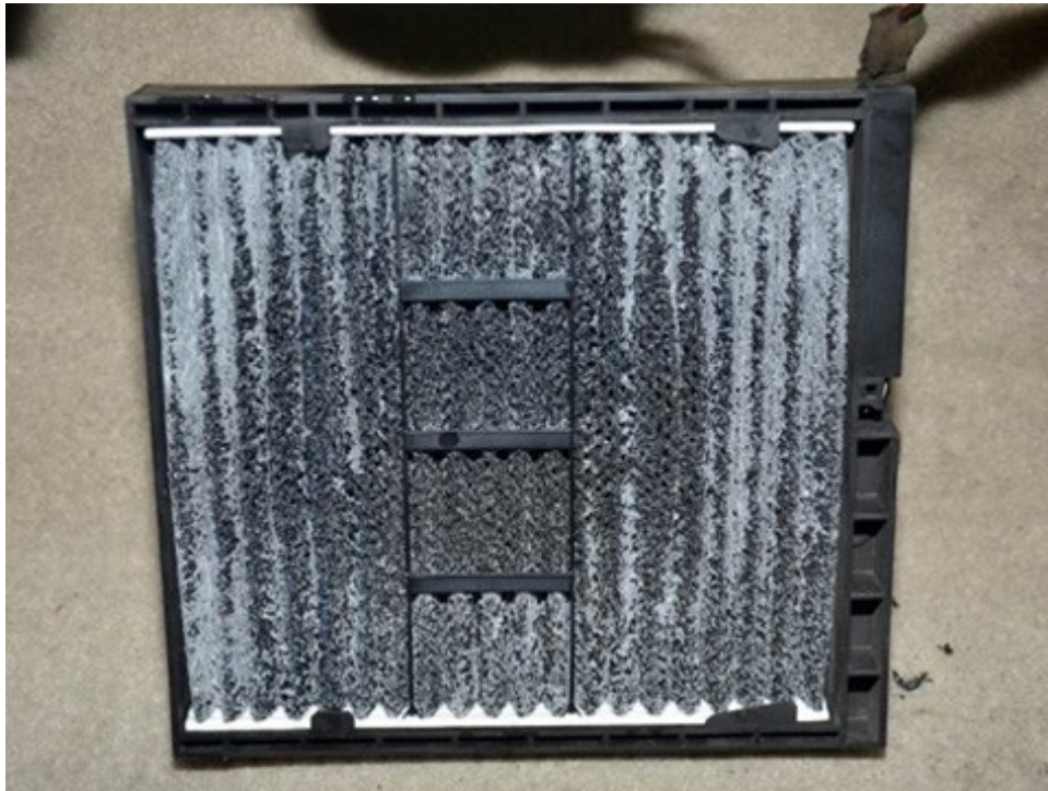
圖 2：將冷氣送風馬達上方臭氧負離子空氣清淨濾網拆下，勘查臭氧負離子空氣清淨濾網內側（靠送風馬達塑膠扇葉側），濾網濾紙燒損碳化嚴重。
