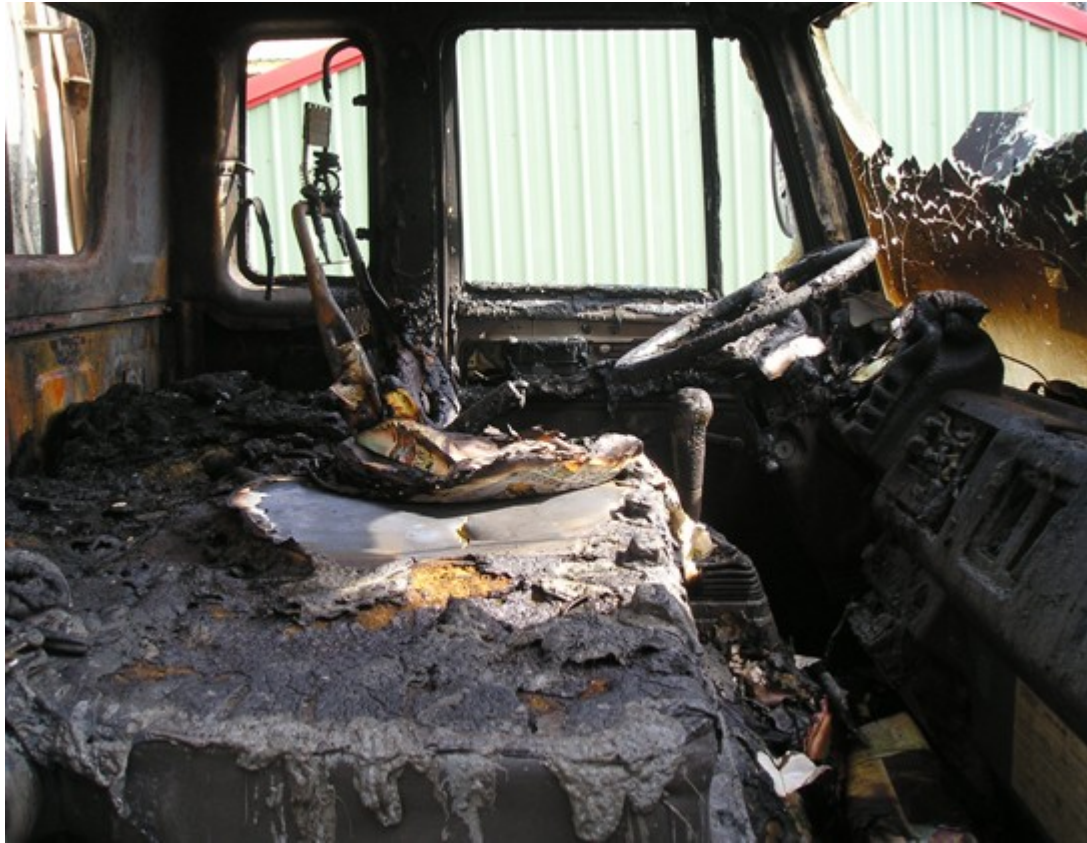
圖 6 左側駕駛座椅子燒毀較為嚴重，旁邊置放書報部分受燒，右側乘客座座椅表面燒熔
