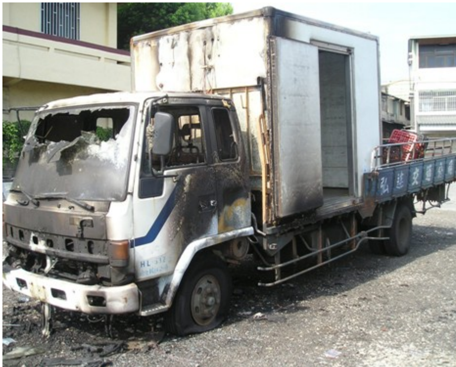
圖3 車頭左側車體外表燻黑，但左下方靠近空氣濾清器部位，受燒變色較為嚴重
