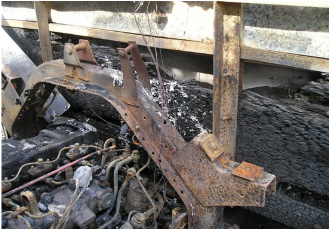
圖 7 引擎部後方車斗受燒碳化最嚴重，引擎內部部分燻黑，發現車頭引擎室連接後貨櫃部分有電線半斷線
