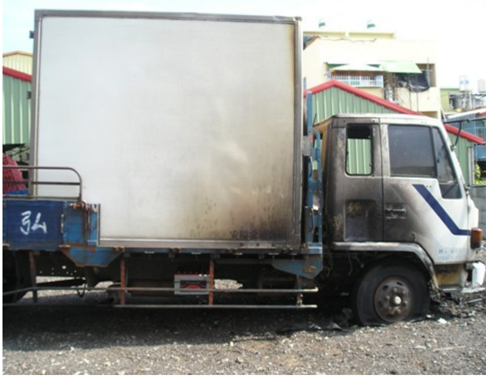
圖 4 車頭右側車體右下方外表燻黑
