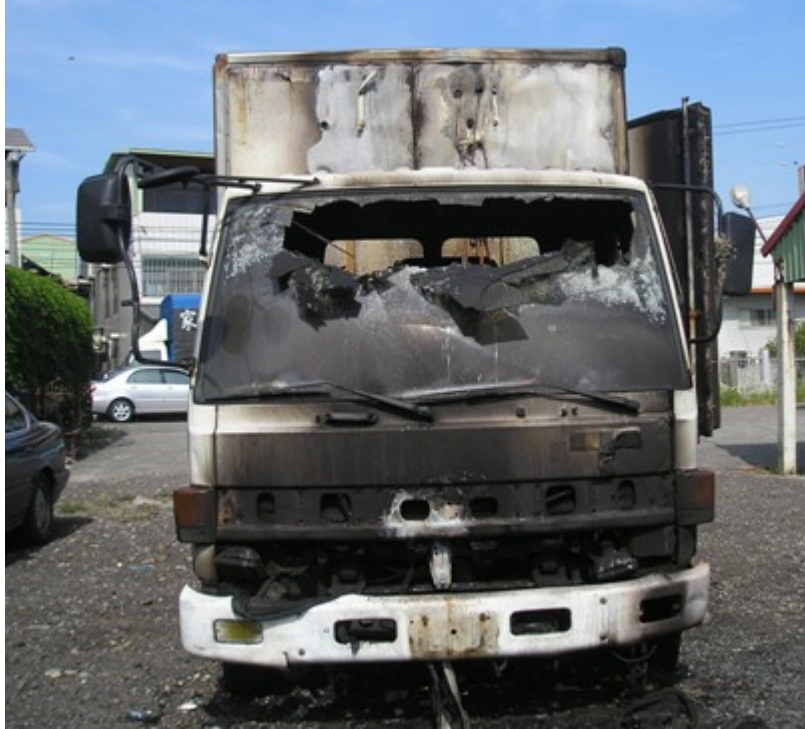
圖2 貨車正面玻璃燒毀往駕駛座方向掉落，車體外表燻黑情形相片
