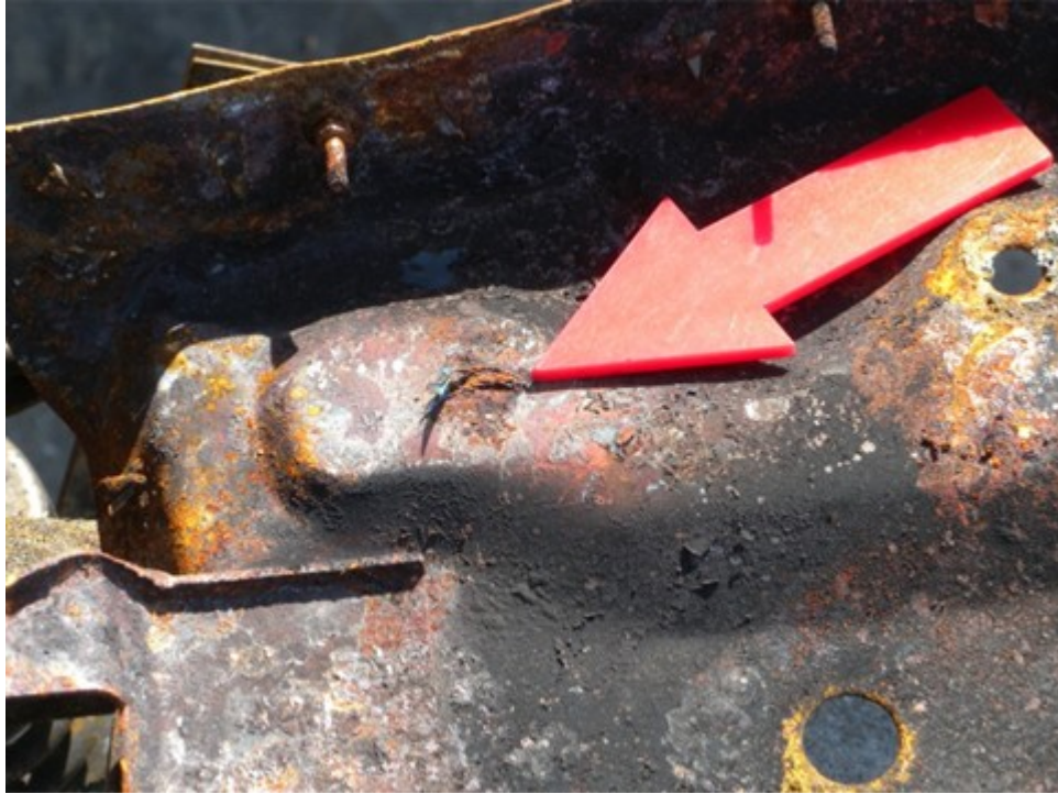
座墊下方受燒情形（箭頭處有電線燒熔）
