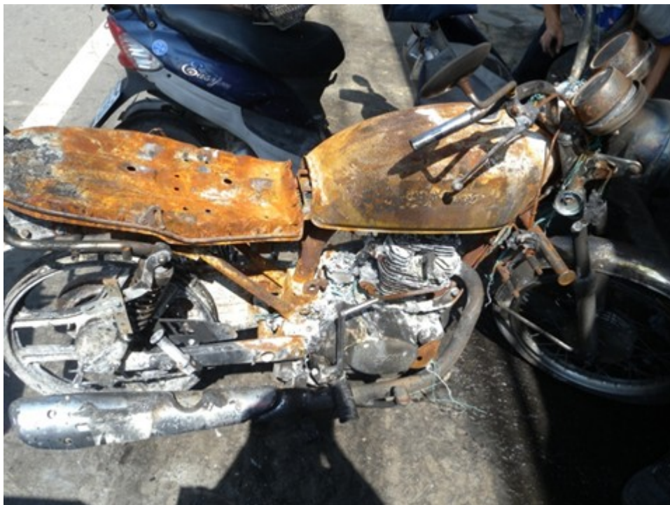
機車受燒情形
