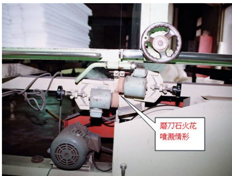
圖 1. 現場模擬直刀機磨刀石研磨刀片時火花噴濺情形
