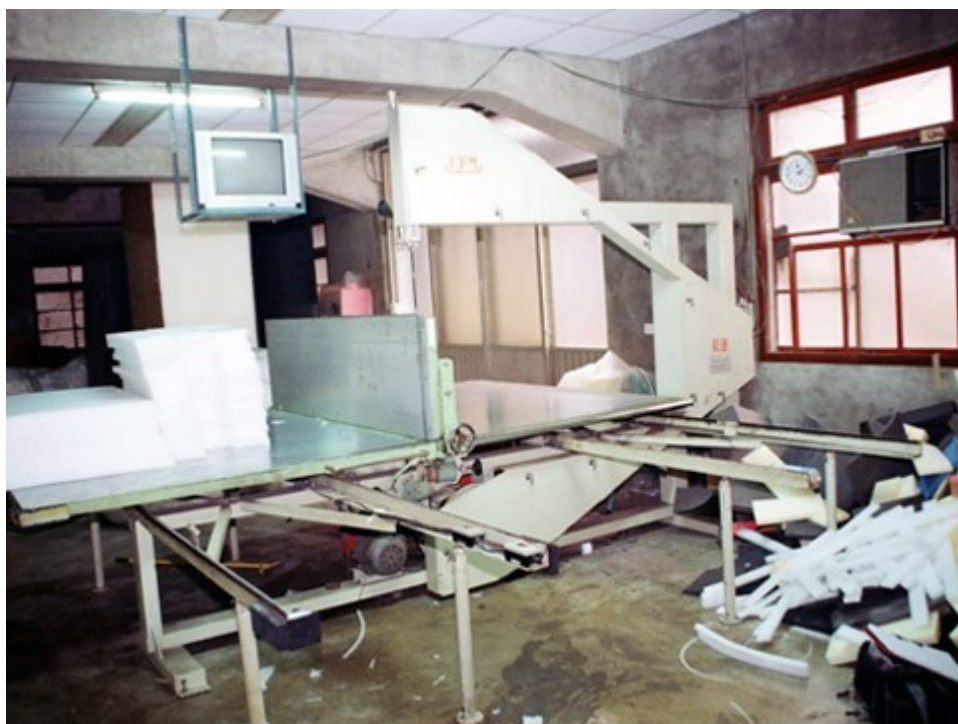
圖 2. 勘查某泡棉工廠同型式泡棉直刀機
