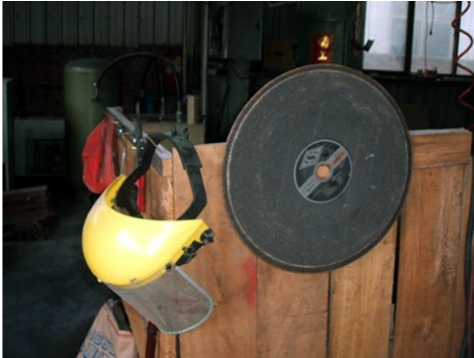
圖 5. 切割機北側工具擺放處，懸掛砂輪切割片
