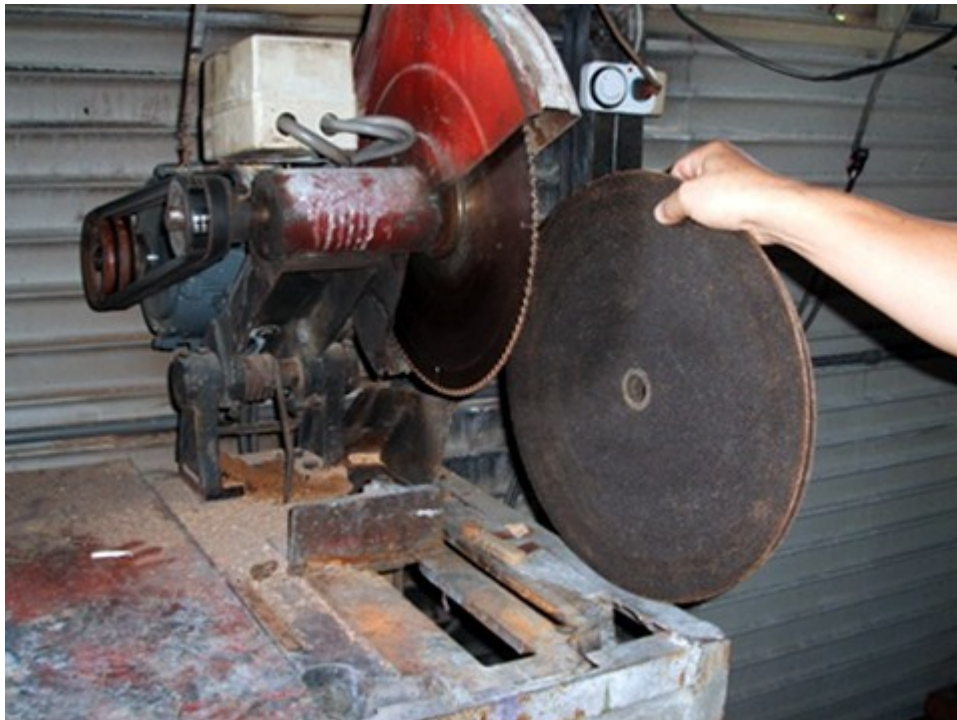
圖 6. 復原砂輪切割片換裝使用情形
