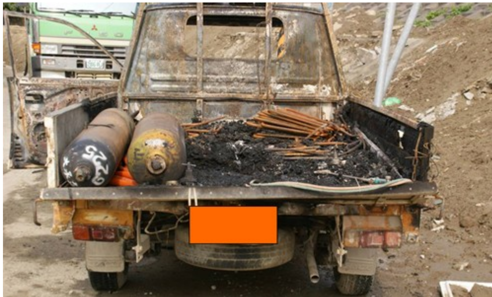
圖1 比對貨床兩邊邊架上板材越靠後端受燒毀越嚴重
