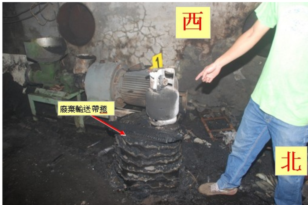
圖 2：據員工林○○表示：置於廠房西側外面瓦斯桶原為放置於廠房西側廢棄輸送帶捲上方，放置位置如標示 1（如指示處）。
