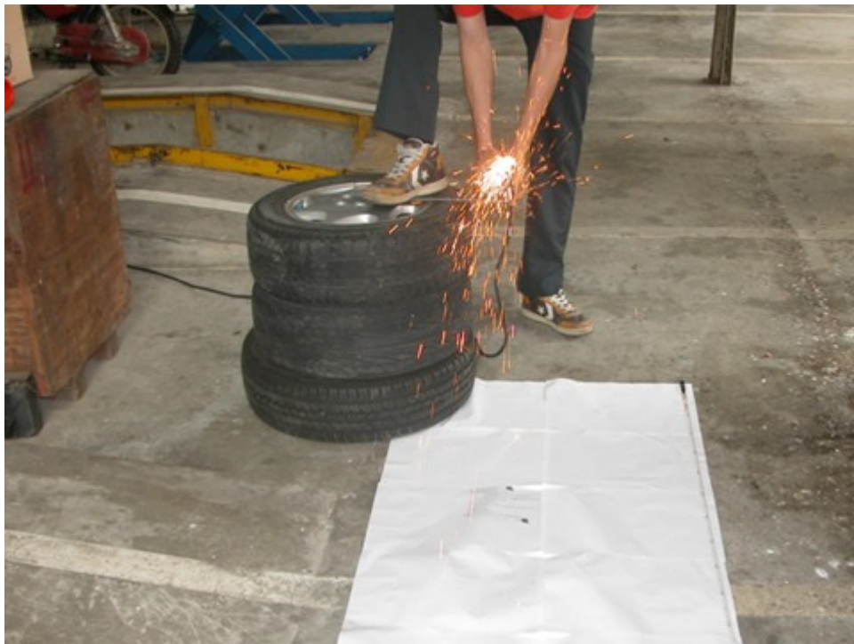
圖 3：砂輪機切割鋼筋火花噴出飛散。
