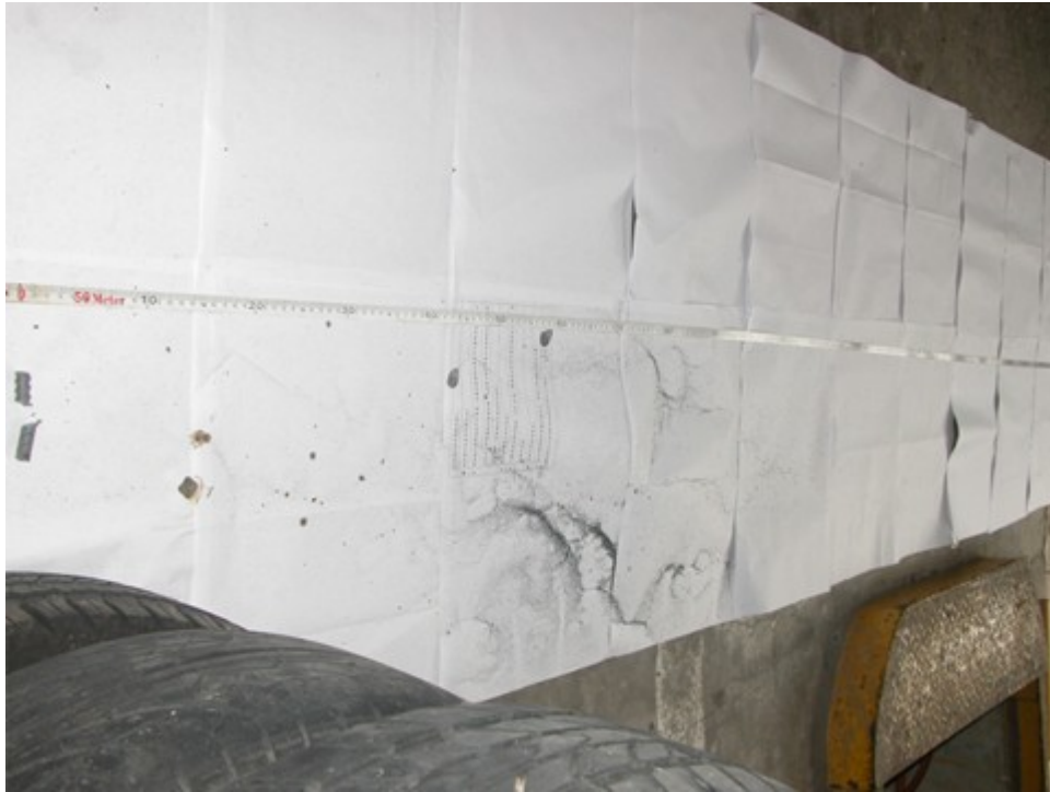
圖 4：火花落點（散落在白紙上）情形如下：火花落點：主要散落在 50~100cm、其次 100~130cm、再其次 130~150cm，最遠可達 250cm。
