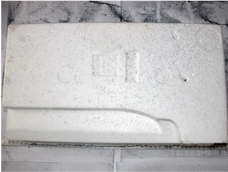
圖 6：保麗龍距離切割處 50~93cm 位置，表面因火花粒徑較小、數量較多，出現許多燒熔之小孔洞。
