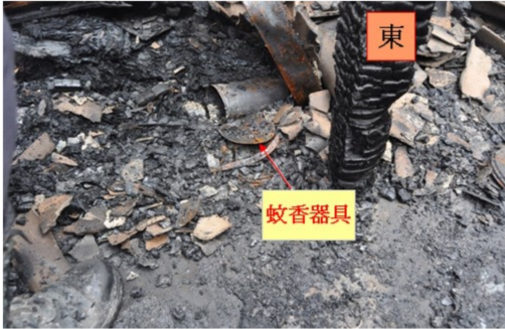
圖 4. 勘查、挖掘床鋪東北側，於碳化物堆中發現蚊香器具。
