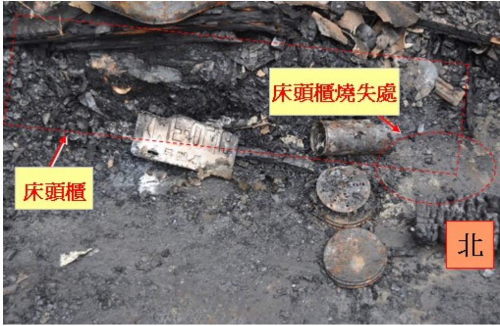
圖 6. 勘查、挖掘放置蚊香器具處，發現緊鄰該處床頭櫃木材燒失情形較嚴重。
