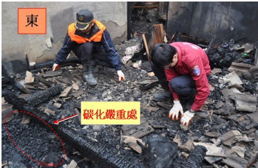
圖 3. 清除地面時發現床鋪北側物品受燒碳化較嚴重。
